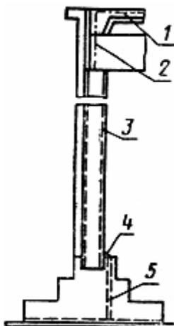
1 - молниеприемная сетка; 2 - токоотвод; 3 - арматура колонны; 4 - заземляющая перемычка;
