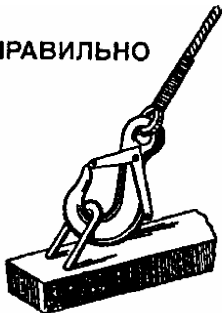
Рис.43. Установка палочного крюка в проушине правильно
