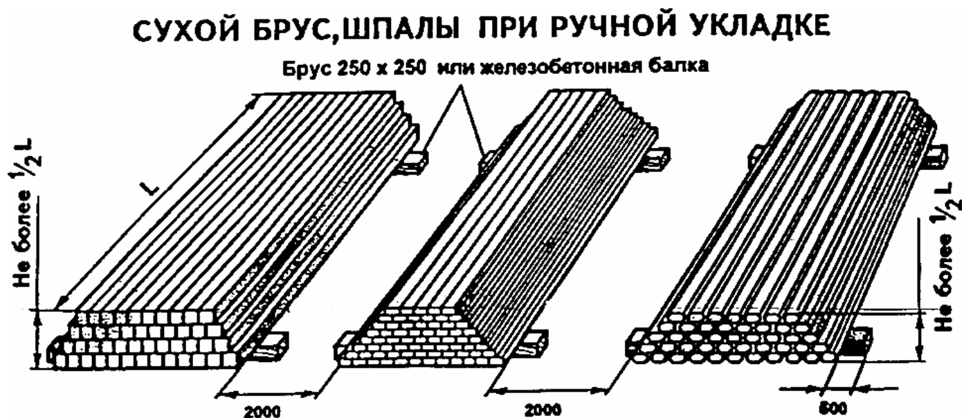
Рис.51. Складирование сухого бруса, шпал при ручной укладке
