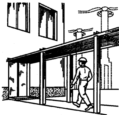
Рис. 8.18. Экранирующий навес над проходом в здание
