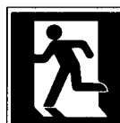
Дверь эвакуационного выхода, открывающаяся с левой стороны
