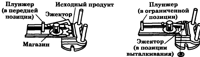
Рис. 5.9. Пример полуавтоматического сброса заготовки
