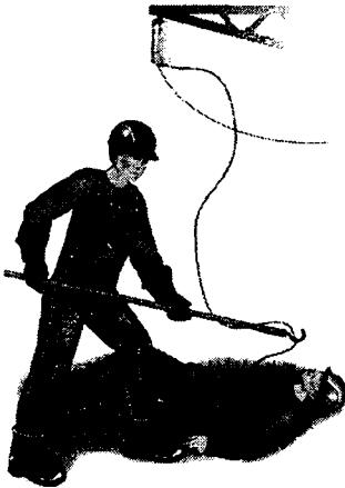
Рис. 6.18. Освобождение пострадавшего от действия тока в установках выше 1000 В отбрасыванием провода изолирующей штангой
