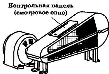
Рис. 5.1. Стационарное внутреннее ограждение
