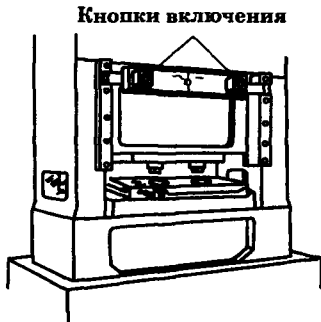
Рис. 5.5. Пример использования двуручного включения
