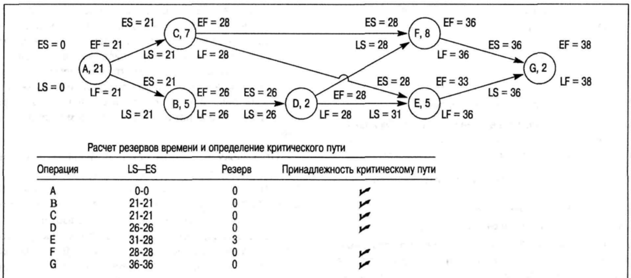
Рис. 3.4. Расчет параметров сетевого графика проекта создания новой модели компьютера
