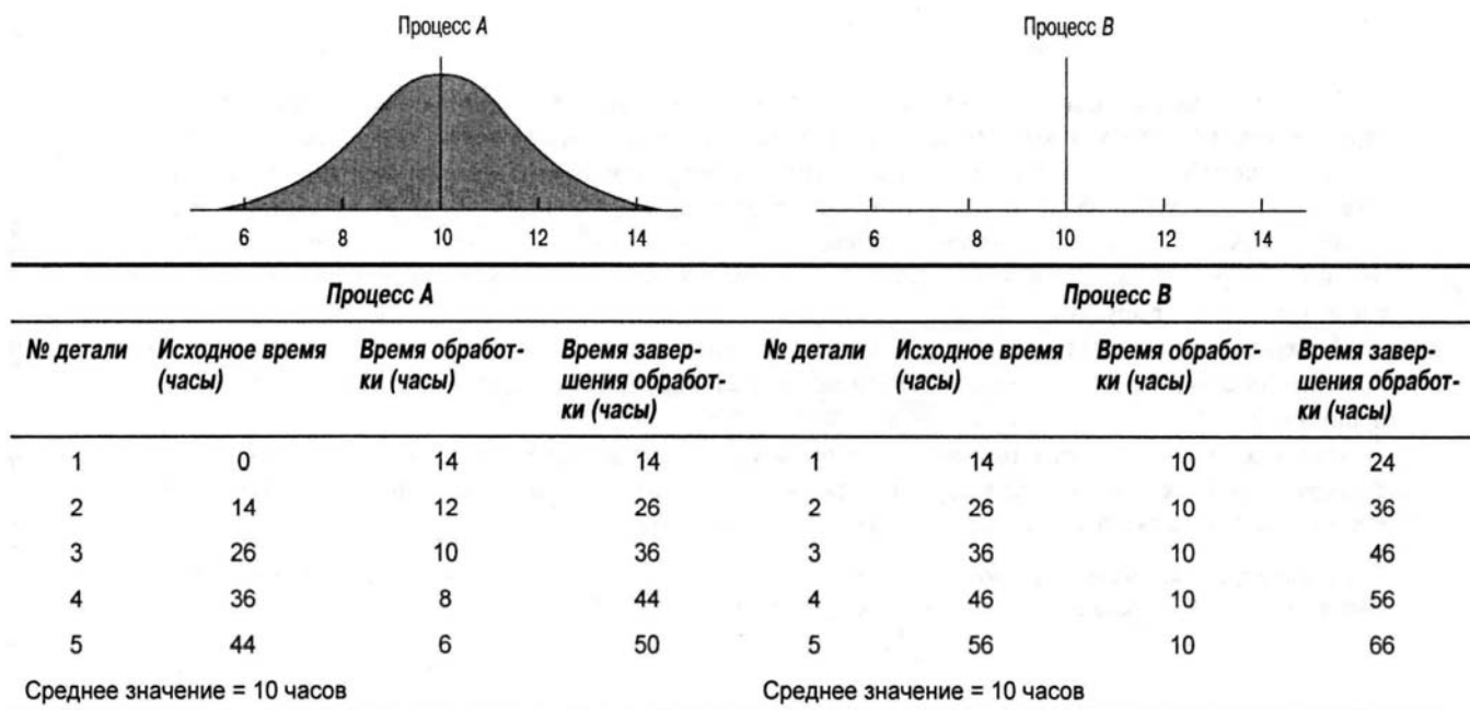
Рис. 20.3. Время обработки и время завершения. Направление от процесса A к процессу B
