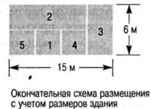
Рис. 10.9. Решение задачи о размещении пяти отделов в магазине методом системной планировки
