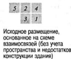
Рис. 10.9. Решение задачи о размещении пяти отделов в магазине методом системной планировки
