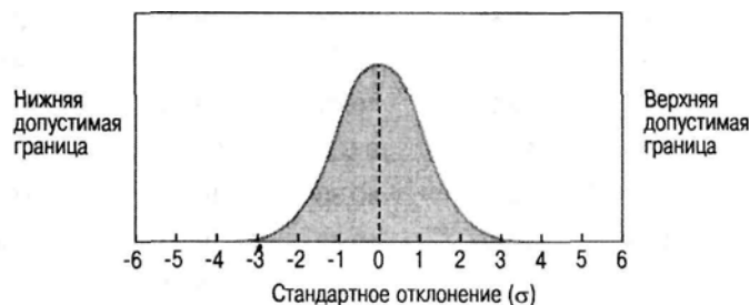
Рис. бд.4. Производственные возможности процесса
