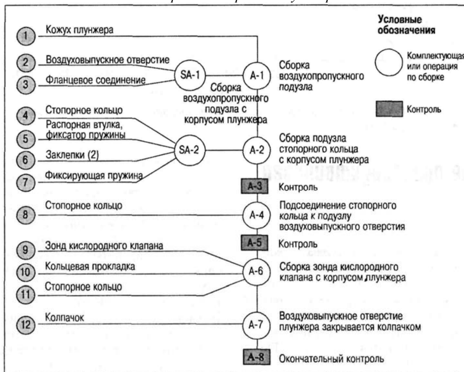
Рис. 4.12. Схема сборки плунжера насоса
