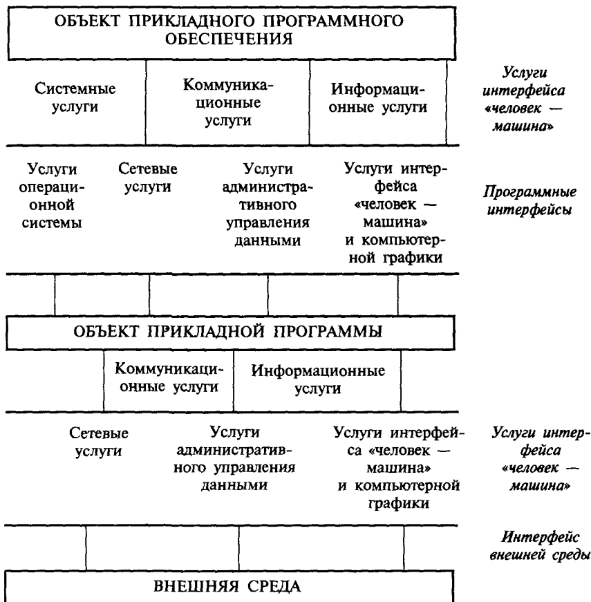
Рис. 2.1. Эталонная модель функционирования среды открытых систем
