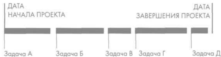
Рис. 3.3. Работа, не привязанная к критическому пути, более реалистична при меньшем напряжении. Обратите внимание на промежутки между задачами
