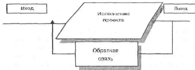
Рис. 15.1.1. Система управления с обратной связью
