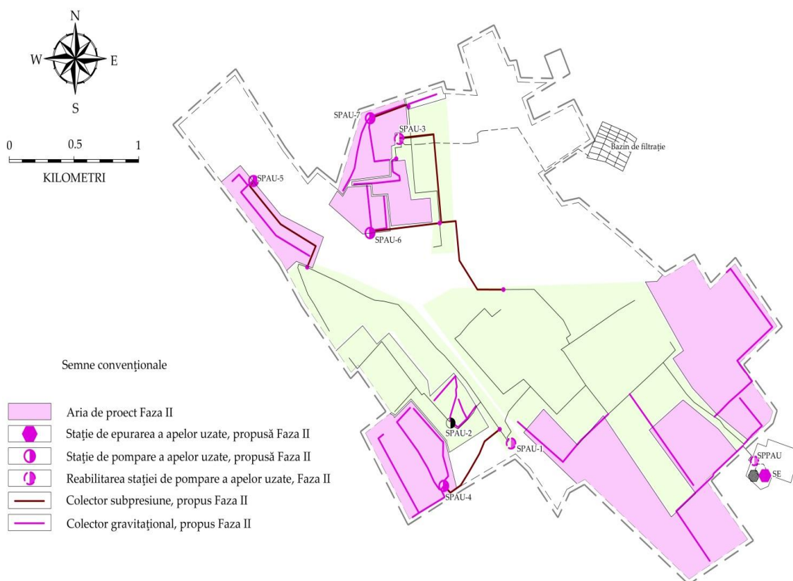
Figura 0-2: Schema sistemului de canalizare existent și propus în orașul Drochia
