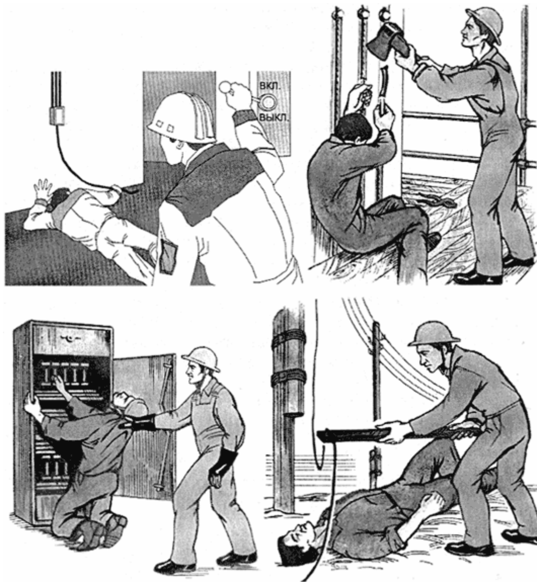
Рис.22. Способы освобождения пострадавшего от действия электрического тока
