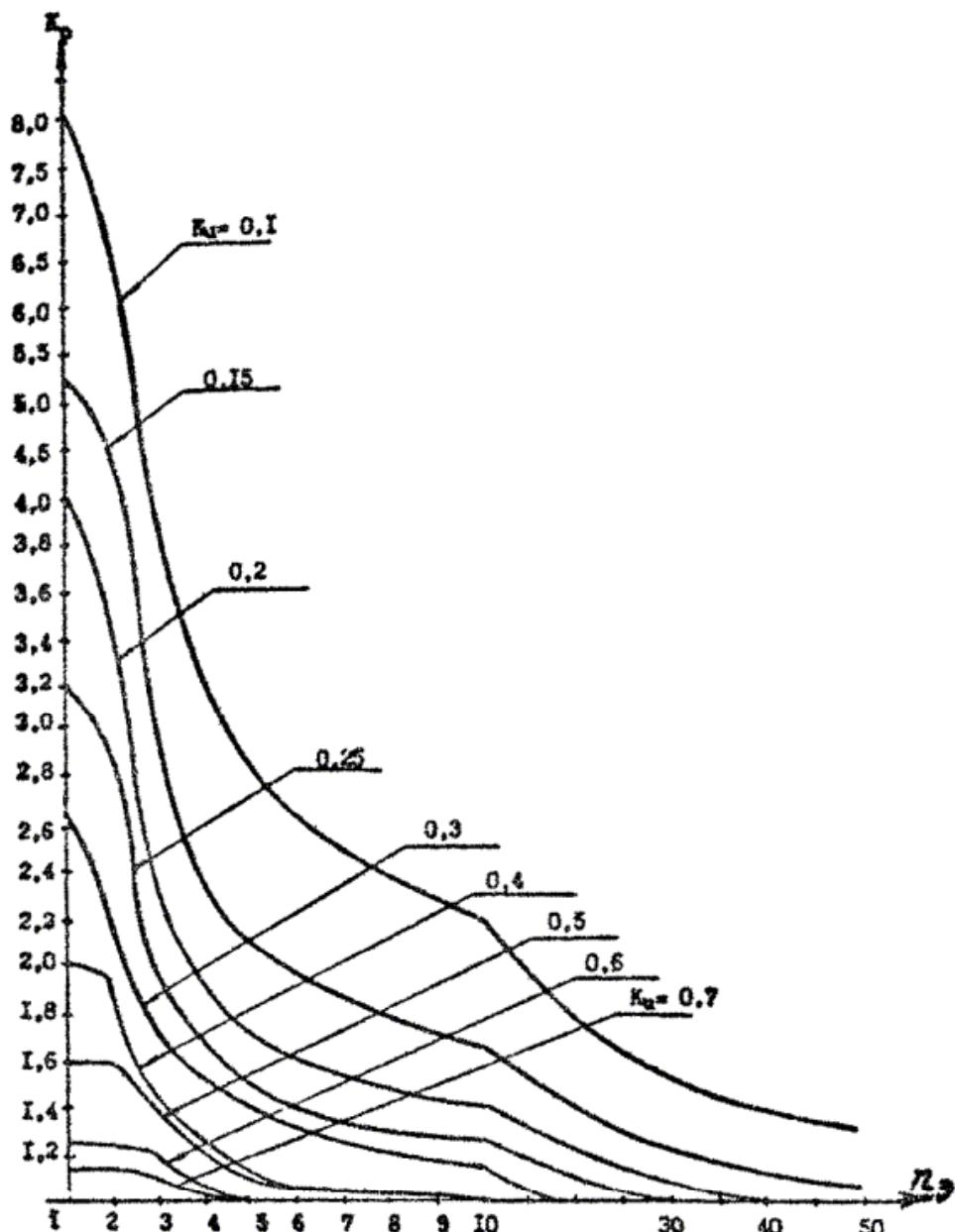
Кривые коэффициента расчетных нагрузок  $K_p$  для различных коэффициентов использования  $K_I$  в зависимости от  $n_3$  (для постоянной времени нагрева  $T_O=10$  мин)
