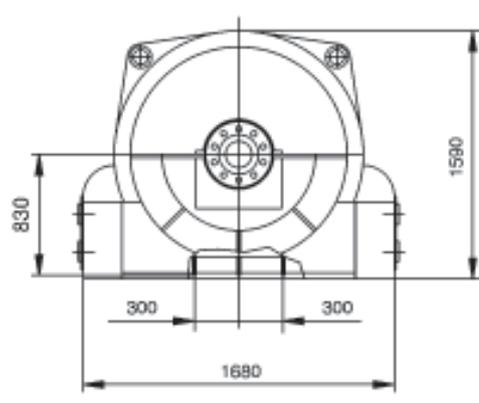
**Турбогенератор типа ТПС-4-2У3 для паровых турбин**
