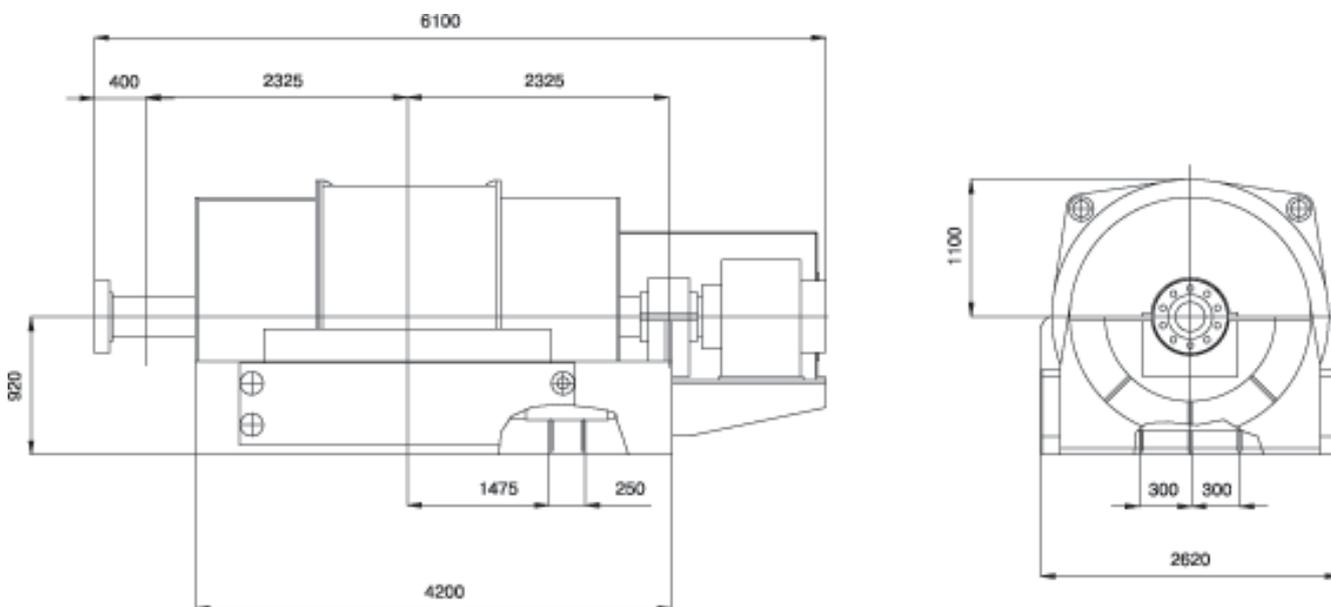
**Турбогенератор типа ТПС-16-2УЗ для паровых турбин**
