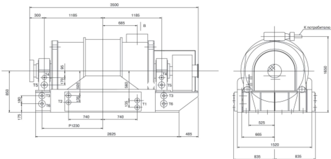
**Турбогенератор типа ТПС-1,5-2У3 для паровых турбин**
