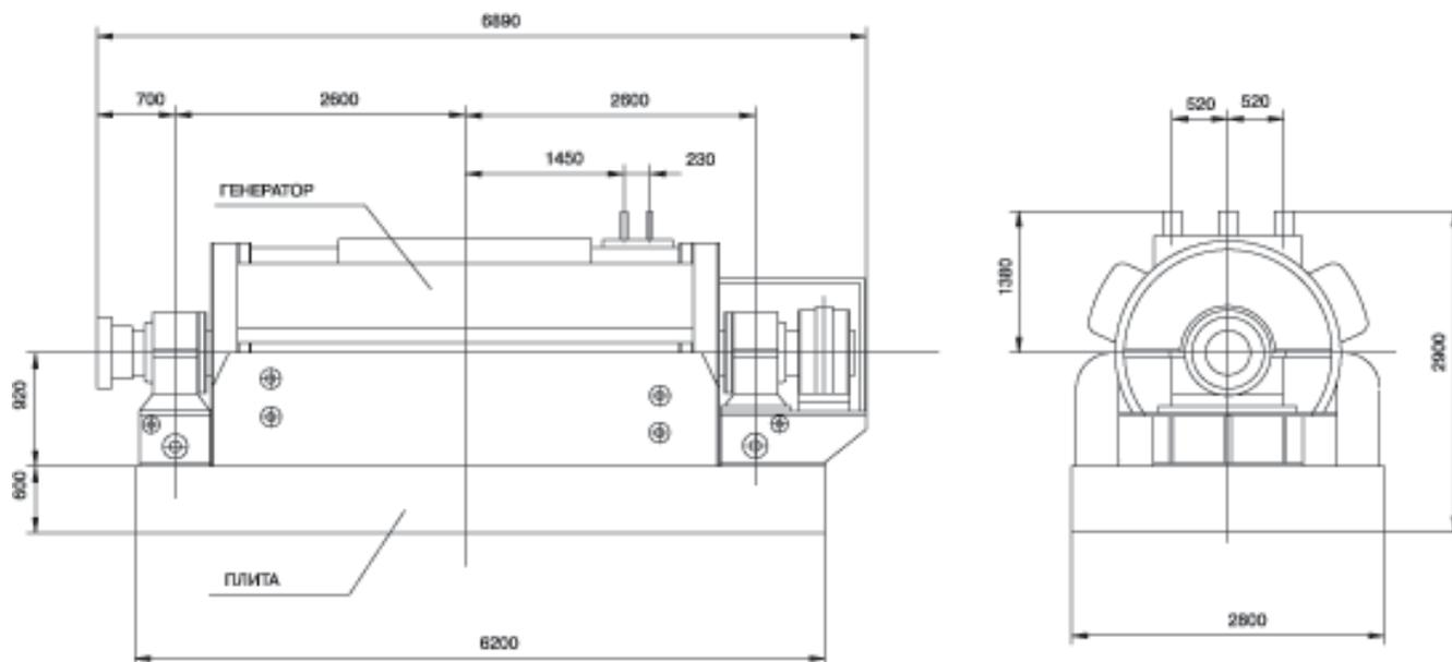
**Турбогенератор типа ТГС-25-2УЗ для газовых турбин**
