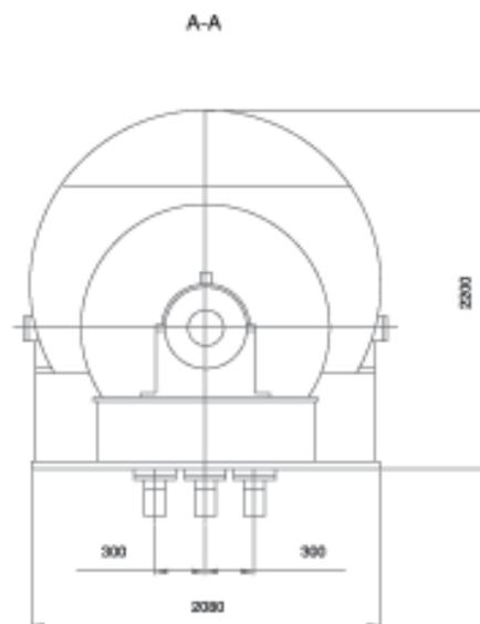
**Турбогенератор типа ТГС-8-2УЗ для газовых турбин**
