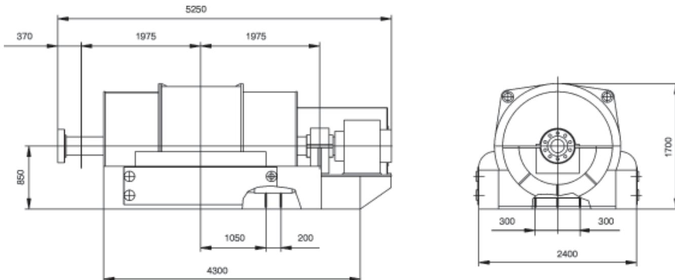
**Турбогенератор типа ТПС-12-2УЗ**
