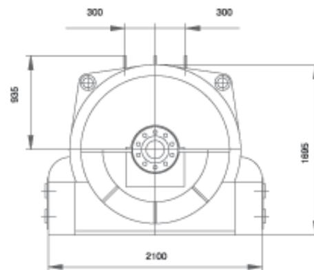
**Турбогенератор типа ТГС-6-2УЗ для газовых турбин**
