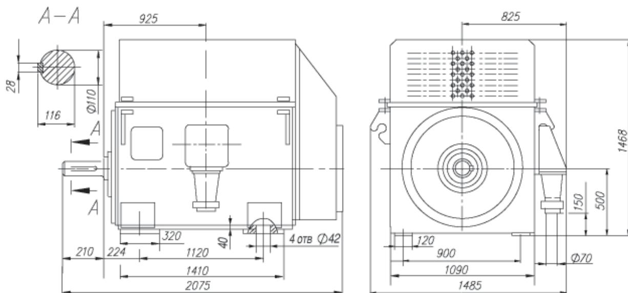
Габаритный чертёж двигателя ДАЗО4 10000 В, 50 Гц
