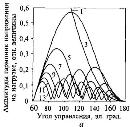
Рис. 6.7. Спектр напряжения (а) и тока (б) при угле сдвига фаз, равном 60 эл. град.
