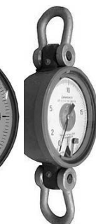
Рис. 2. Динамометры пружинные на усилие от 10 кгс до 500 кгс
