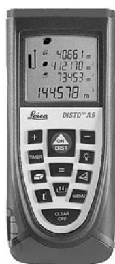
Рис. 1. Лазерный дальномер-рулетка Leica DISTO A5
