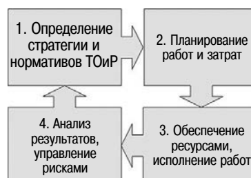
Рис. 2. Цикл управления ТОиР при постоянную оценку результатов ремонта
