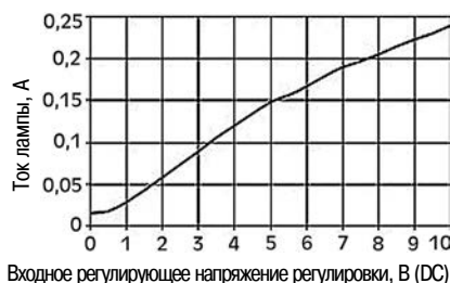
Рис. 5. Зависимость тока лампы от регулирующего напряжения
