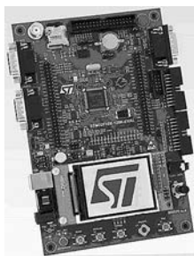
Рис. 2. Отладочная плата микроконтроллеров STM32
