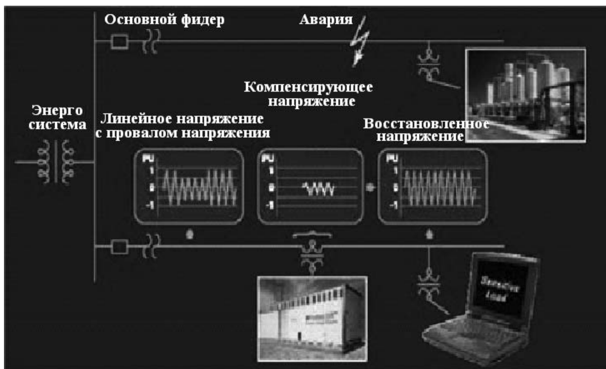
Рис. 2. Диаграмма работы ДКИН при нарушениях электроснабжения
