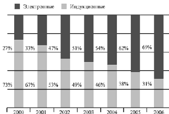
Рис. 1. Замещение индукционных счетчиков электроэнергии электронными
