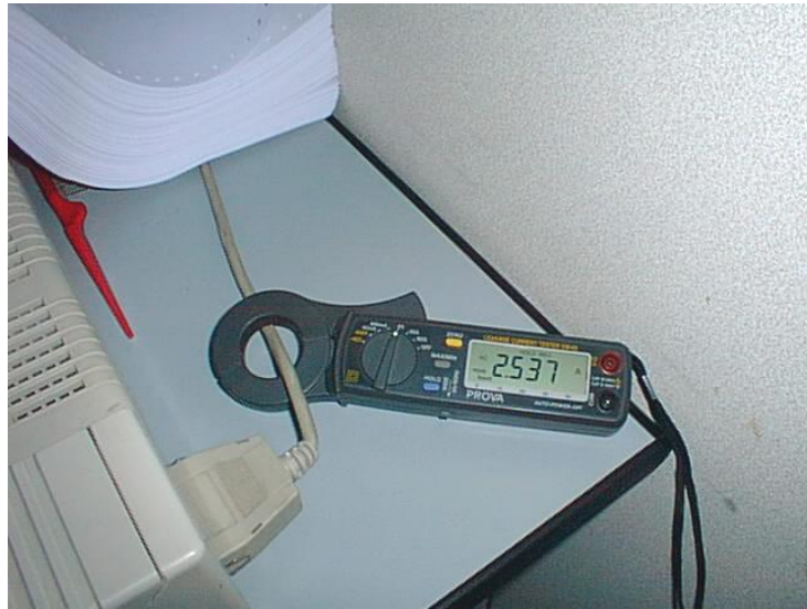
Рис.4. Ток по интерфейсному принтерному кабелю параллельного (LPT) порта
