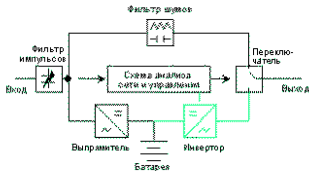
Рис. 9. Работа ИБП с переключением от сети.
