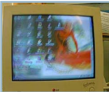
Повышенный фон магнитного поля промышленной частоты
