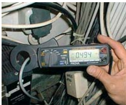
Переменный ток промышленной частоты по информационному сетевому кабелю – 0,49А
