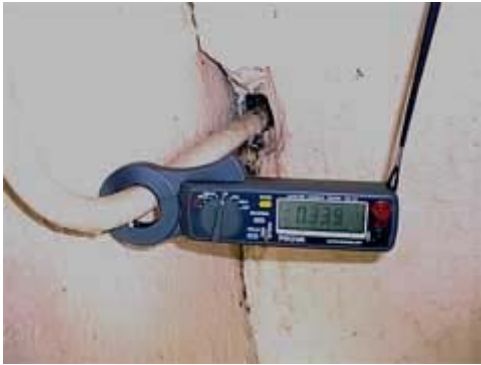
Ток 0,34 А по трубопроводу системы подачи кислорода
