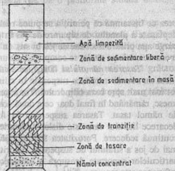
Fig. 5.3. Reprezentarea schematică a sedimentării „în masă” („frănată”).
