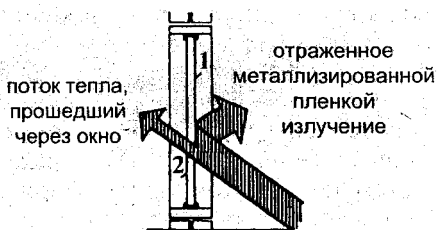
Рис. 8.8.3. Установка метал- лизированной пленки: 1 — стекло, покрытое метал- лизированной пленкой, 2 — стекло из пленки.
