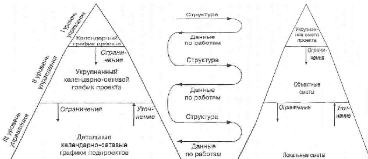
Рис. 13.10.1. Взаимосвязь календарно-сетевого планирования и разработки сметной документации
