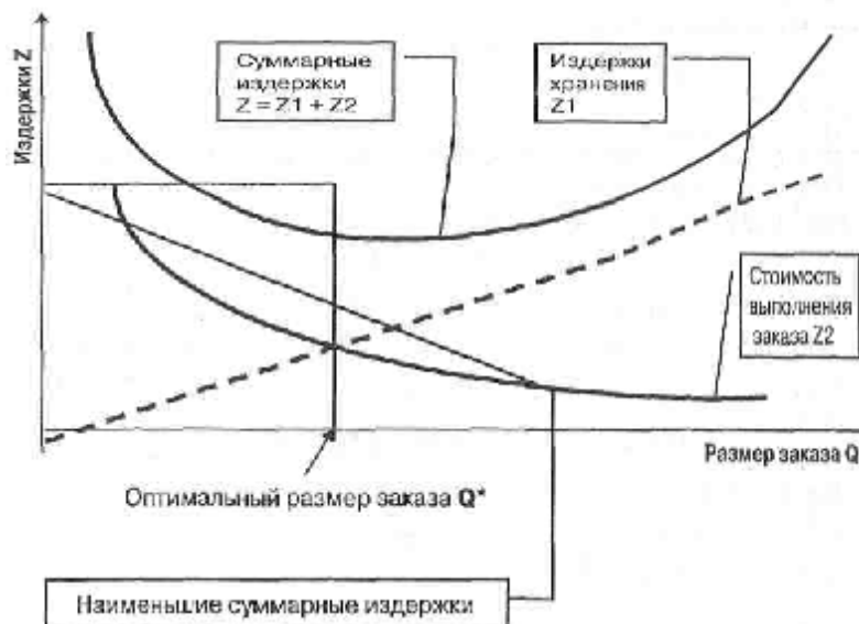
Рис. 19.5.1. Пример определения оптимального размера заказа ресурса
