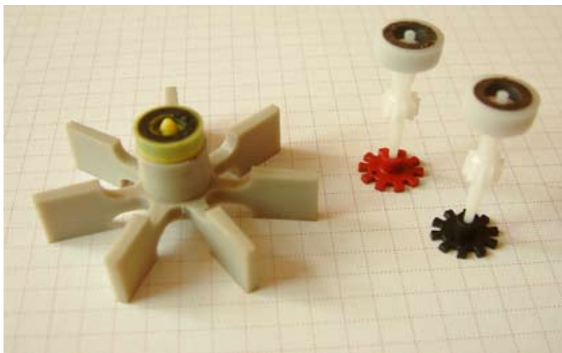
Рис. 3. Общий вид деталей крыльчатки счётчика воды: - крыльчатка с магнитной полумуфтой (слева); - оси счётных механизмов с магнитными полумуфтами (справа).
