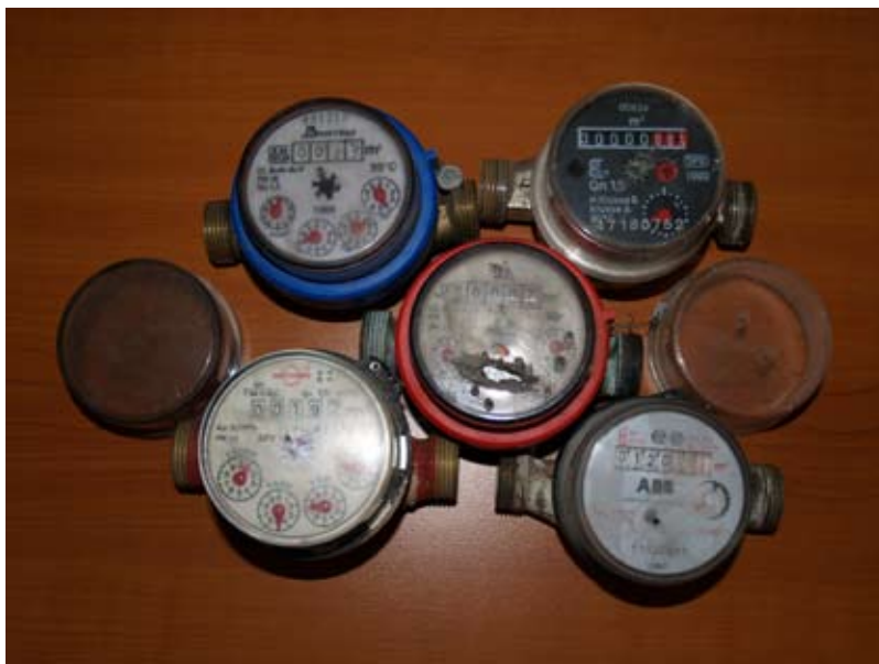
Рис. 1. Несанкционированные воздействия через пластмассовый колпак счетчика.
