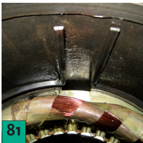
81 Extraiga el anillo de retención.
