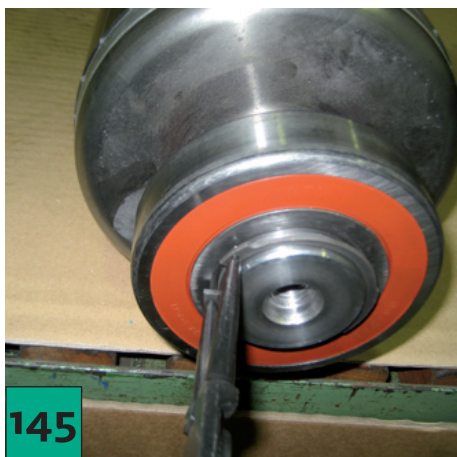
Coloque la anilla de retención.
