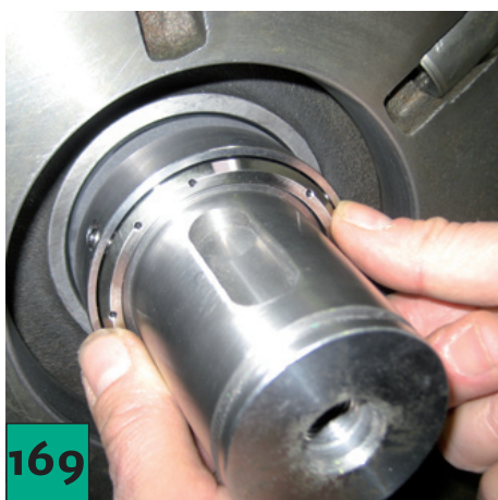
Coloque la parte inferior del sello mecánico...
