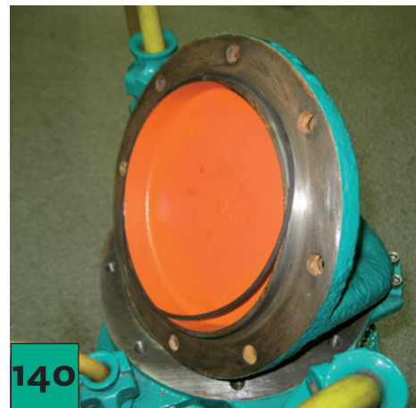
Coloque la junta tórica en la tapa del motor.
