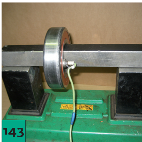
Caliente el rodamiento de bolas superior 80 grados por encima de la temperatura ambiente.
