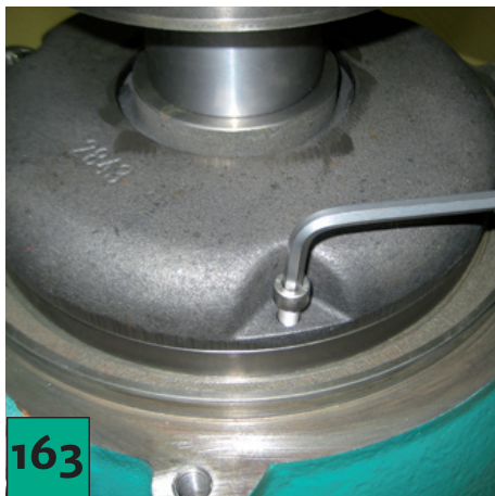
Coloque el difusor y fíjelo con los tornillos allen.
