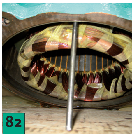
82 Incline la carcasa del motor y extraiga la barra antirotación.
