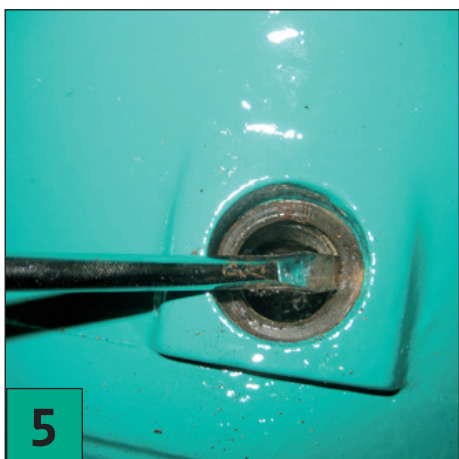
Si es necesario, extraiga la junta circular de poliamida con el destornillador.
