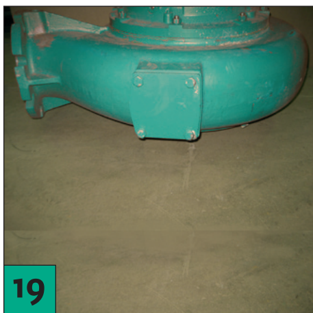
Apoye el grupo de bombeo sobre una superficie plana.
