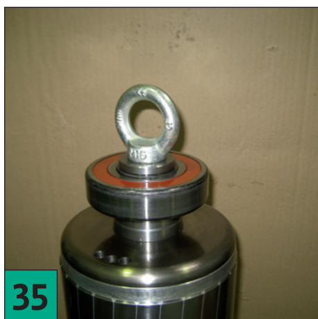
Enrosque el cáncamo en el eje del motor.
