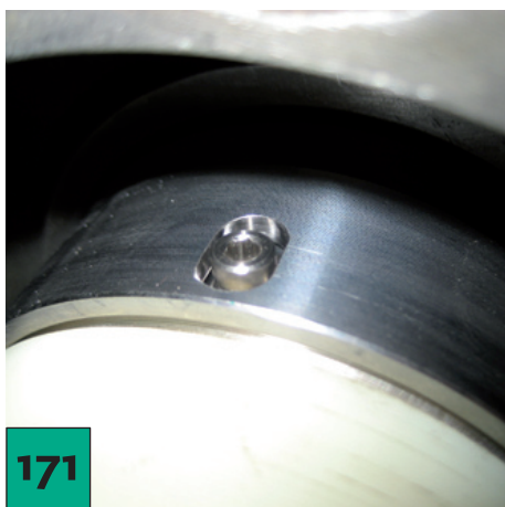
...los tornillos de tornillos de apriete queden en el centro de la ranura del rodamiento.
