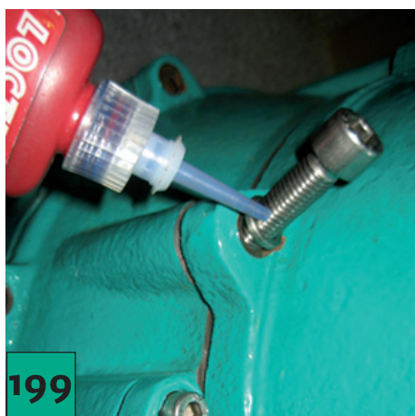
Aplique Loctite 243 a los tornillos de fijación de la carcasa del motor...
