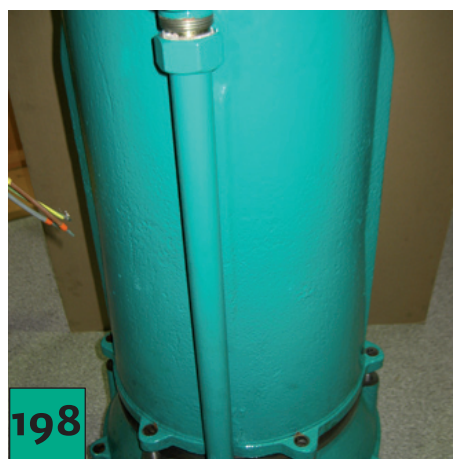
...prestando atención a que la tubería de refrigeración quede introducida en el racor roscado.
