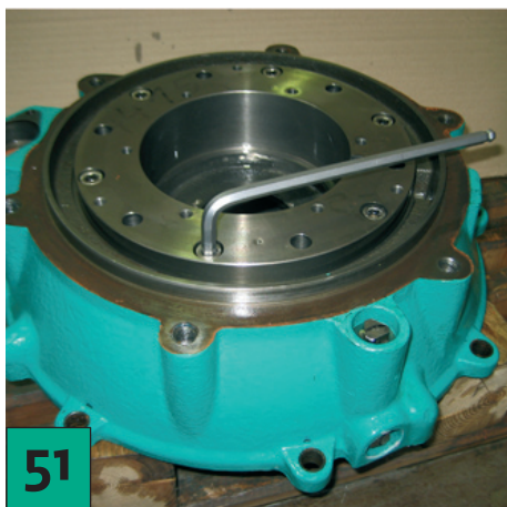
Desenrosque los tornillos de la caja inferior del rodamiento.
