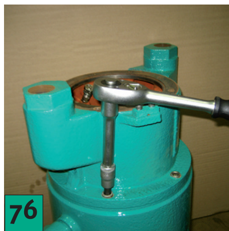
Desenrosque los tornillos de fijación de la caja del rodamiento superior.
