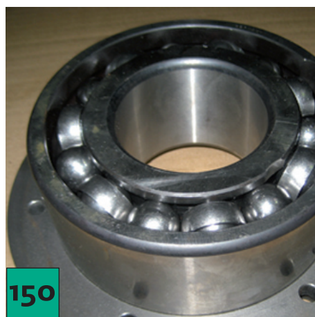
Coloque el rodamiento inferior en la tapa del rodamiento. ¡Atención! ¡Con la cavidad hacia abajo!
