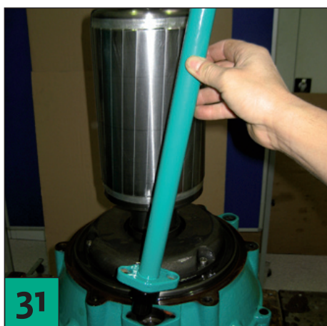
Retire la tubería de refrigeración.
