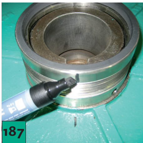
187 Marque la posición del chavetero del rodete.
