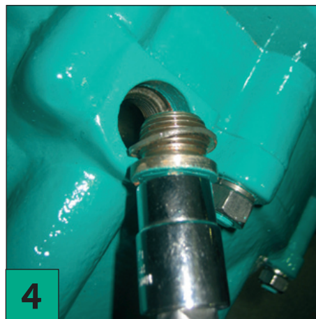
Extraiga el tapón de cierre junto con la junta circular de poliamida.
