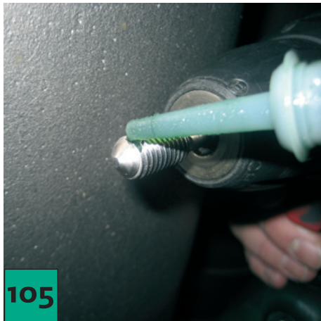
Aplique al espárrago roscado Loctite 2701 "verde".
