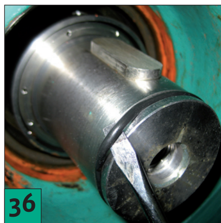
Retire la junta tórica del extremo del eje del motor.
