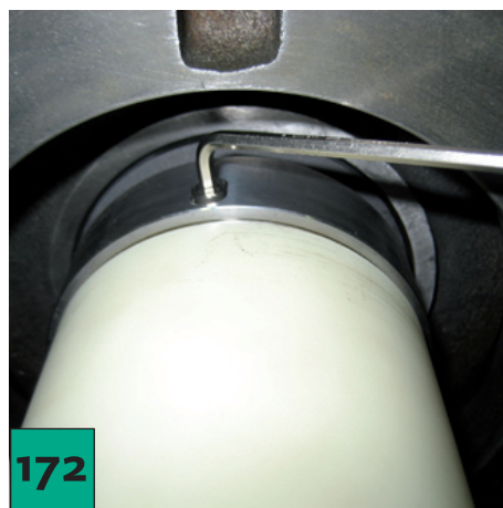
Apriete los tornillos con una llave allen.
