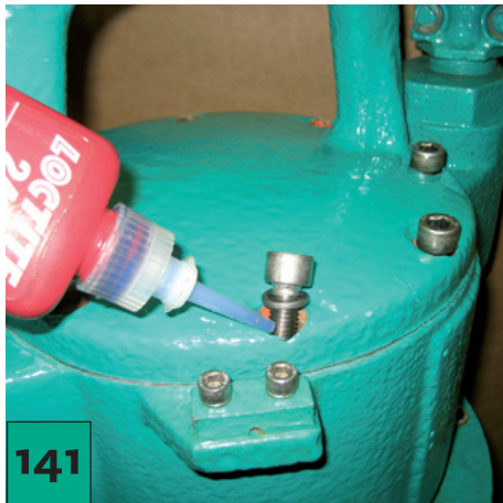
Coloque la tapa del motor sobre la caja superior del rodamiento enrosque los tornillos allen con la anillas elásticas (Loctite 243)...
