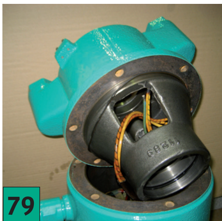
79 Eleve la caja del rodamiento superior.
