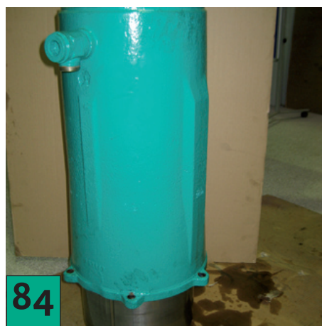
84 Eleve la carcasa del motor.
