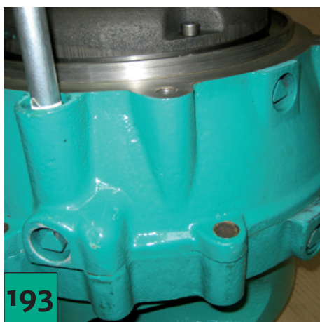
Enrosque el manómetro en la cámara de obturación...
