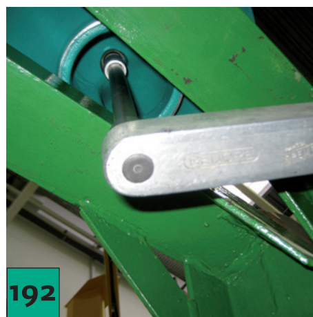
192 ...en el rodete y apriételo con la llave dinamométrica (155 Nm).
