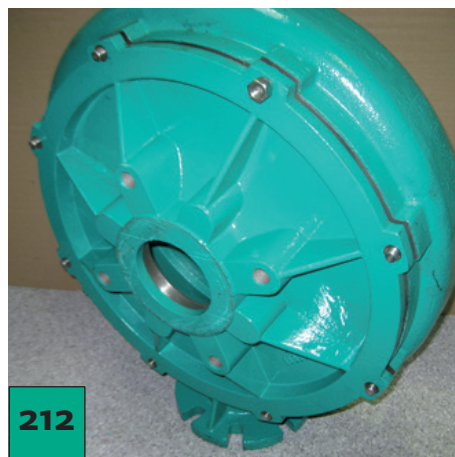
Encaje la tubuladura de aspiración en la carcasa de la bomba...
