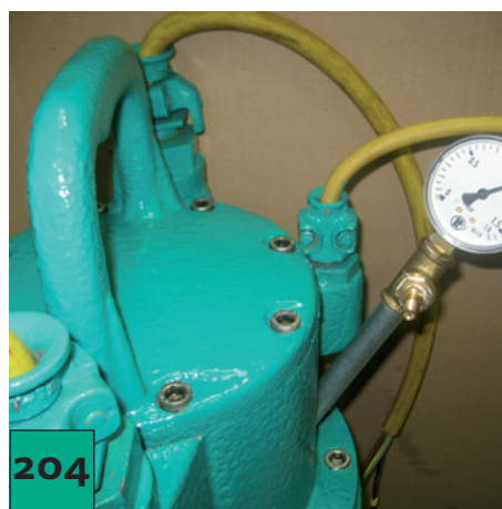
Enrosque el manómetro de prueba en el motor...
