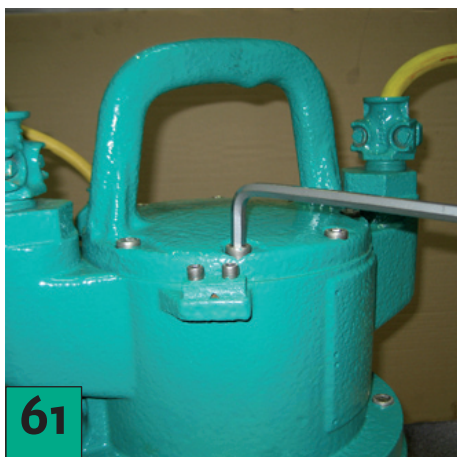
Retire los tornillos allen de la tapa del motor.
