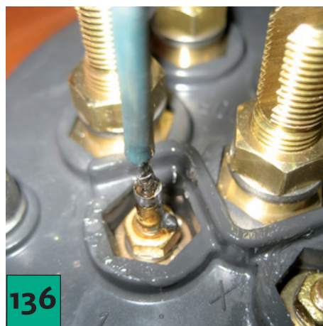
...introduzca el cable de control y deje que se enfríe.
