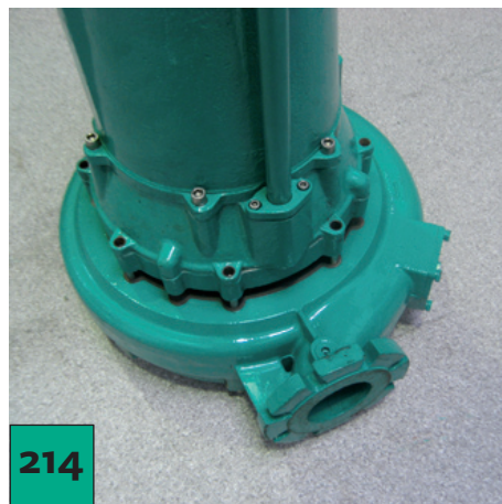
Coloque el motor encima de la carcasa de la bomba.
