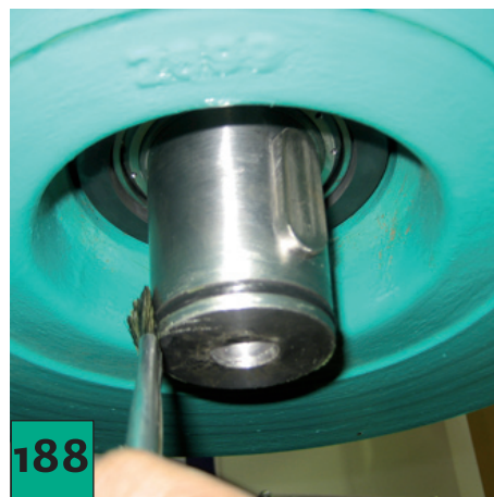
188 Aplique grasa exenta de silicona a la junta tórica del extremo del eje del motor.
