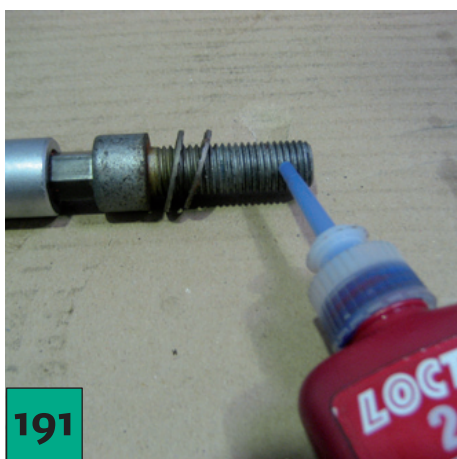
191 Enrosque el tornillo de fijación con la arandela Nord Lock (Loctite 243)...
