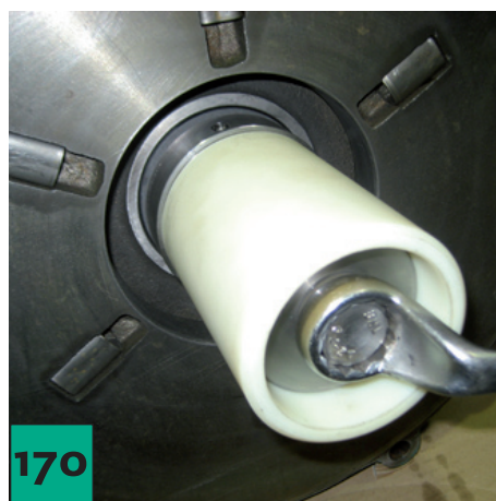
...y fíjelo con el casquillo de montaje hasta que...
