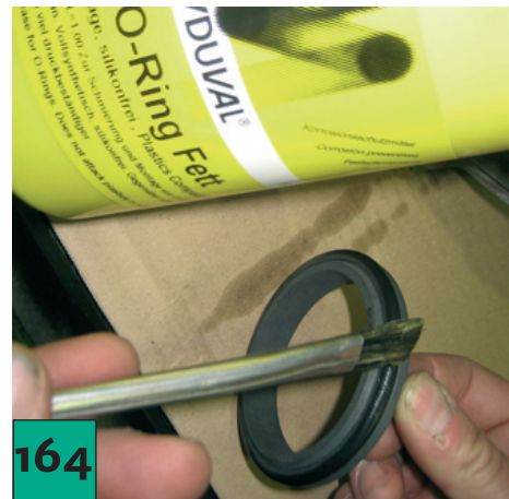
Engrase ligeramente la junta tórica del contraanillo del sello mecánico superior con grasa exenta de silicona.
