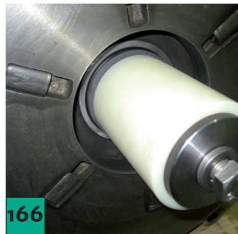
...y encájelo con un casquillo de montaje.
