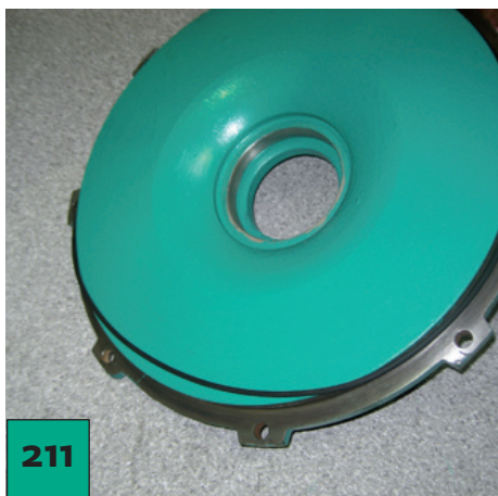
Coloque la junta tórica en la tubuladura de aspiración.
