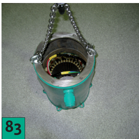
83 Una la cadena a la carcasa del motor.
