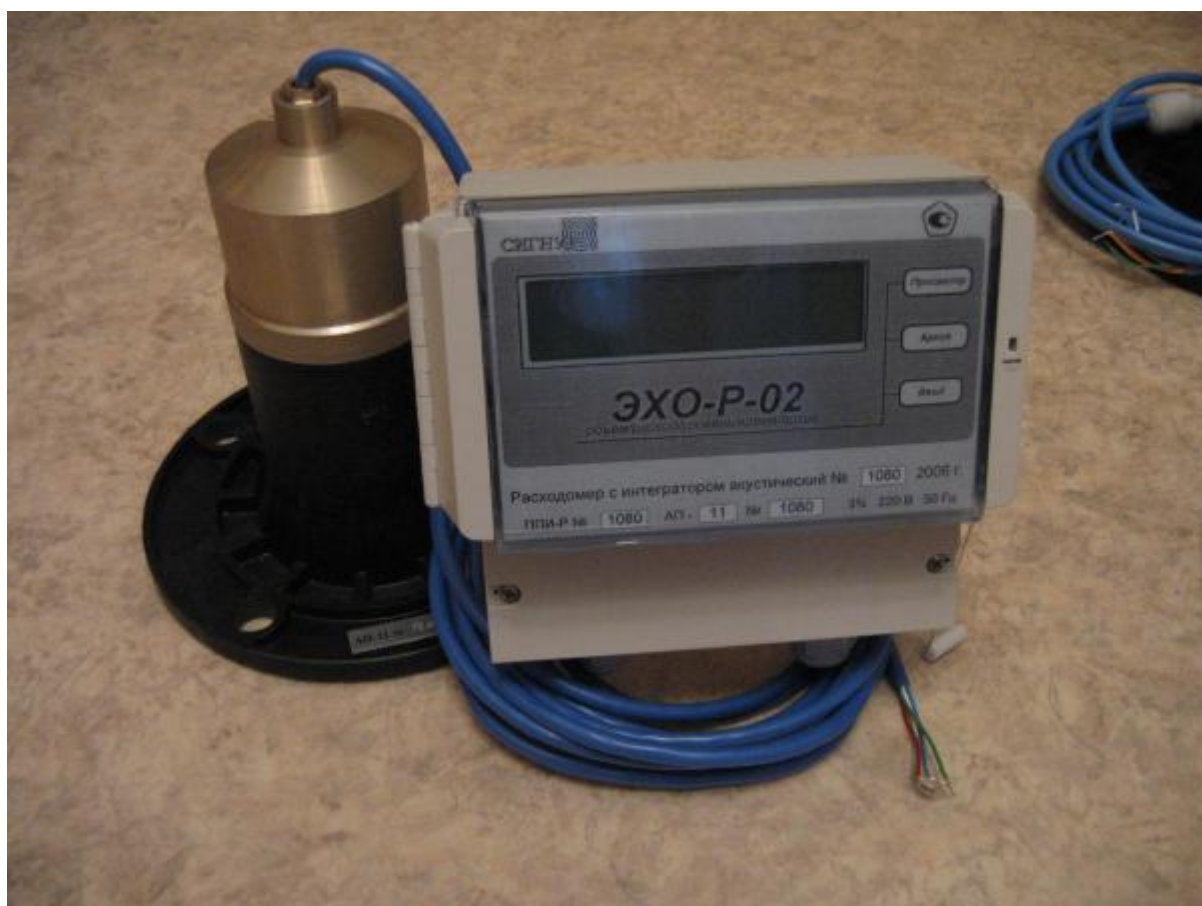
Расходомер для безнапорных каналов ЭХО-P-02, реализующий метод переменного уровня
