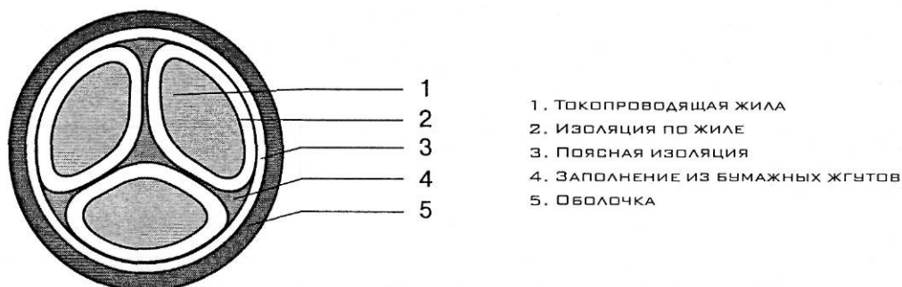
Рисунок 2.2.1-1. Конструкция кабеля марки ААГ с секторными жилами.
