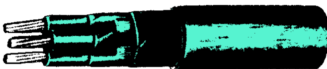
Рисунок 5.3. Кабель силовой трехжильный с резиновой изоляцией в свинцовой оболочке на напряжение 660 В без защитного покрова марки СРГ
