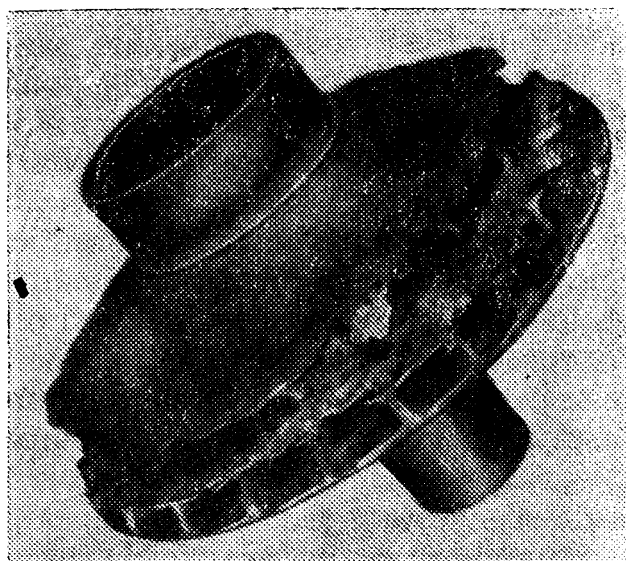
Fig. 4.2. Rotorul uzat al unei pompe pentru produse chimice.
