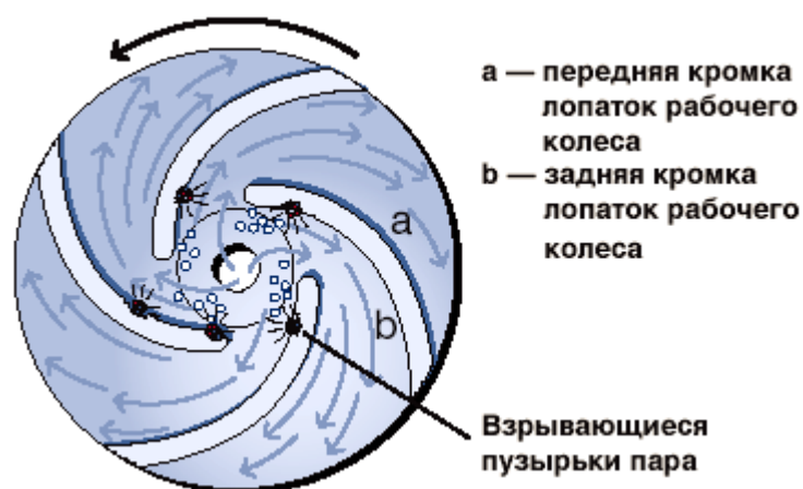
Рис. 42. Схема появления и перемещения пузырьков пара на рабочем колесе
