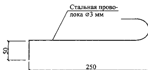
Рисунок 9 - Щуп для замера величины зазора между торцами стыкуемых труб
