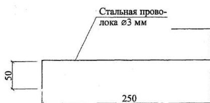
Рисунок 6 - Щуп для замера величины зазора между торцами стыкуемых труб
