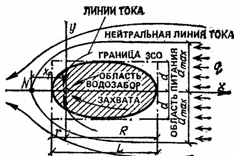
62. Схема фильтрации подземных вод к водозабору
