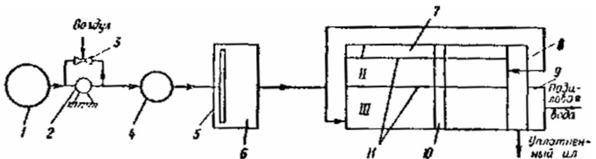
Рис. 22. Схема флотационного уплотнителя избыточного активного ила (ИАИ)
