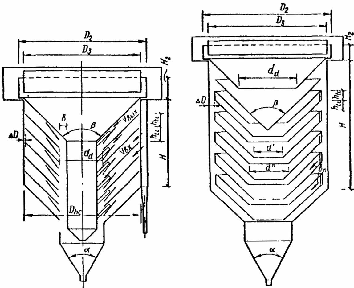
Рис. 8. Схема многоярусного гидроциклона с центральными выпусками
