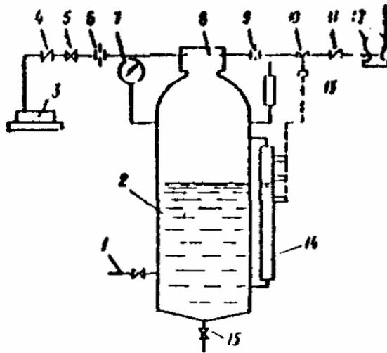
Рис. 19. Схема узла насыщения рециркулирующей части осветленной воды
