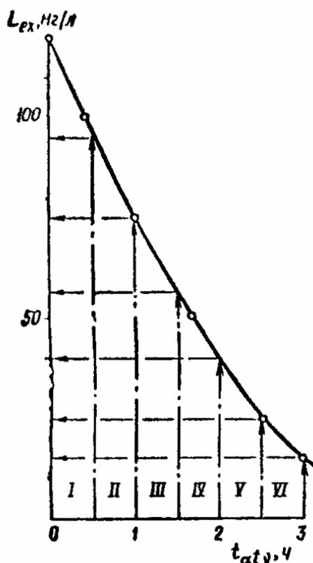
Рис. 13. Зависимость  $L_{ex}$  от продолжительности пребывания в аэротенках-вытеснителях
