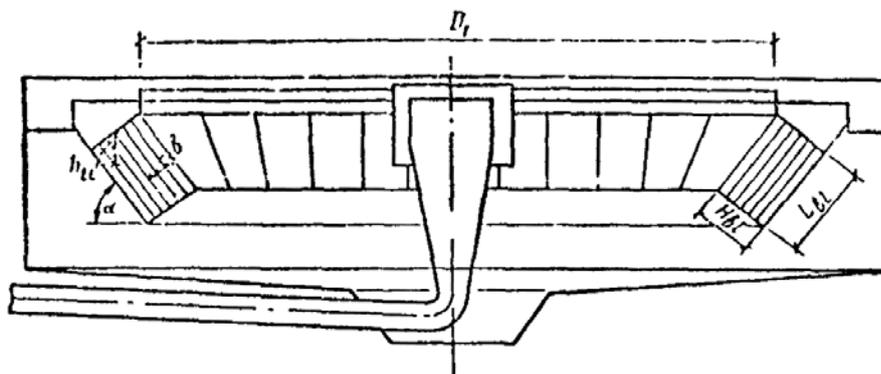
Рис. 6. Схема радиального отстойника дополненного тонкослойными блоками (модулями)
