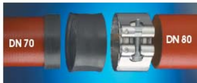
2. Резиновый уплотнитель одевается на трубу DN 70
