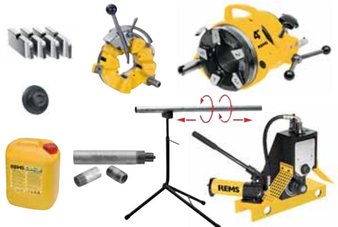
Надежный, компактный высокопроизводительный станок для нарезания резьбы, резки труб, снятия грата, изготовления ниппелей (бочат), накатки желобков. Для монтажников, металлообрабатывающей отрасли и промышленности. Для стройплощадки и мастерской.
