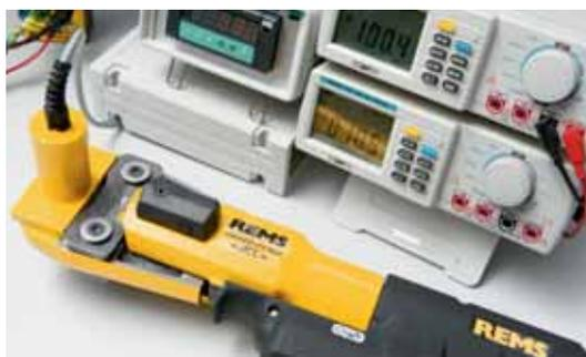
Сервис в REMS – сервис с большой буквы: все презентационные машины 200-и консультантов REMS снабжены испытательным приспособлением, с помощью которого везде на месте можно осуществит проверку работы и силы сжатия радиальных прессов REMS.
