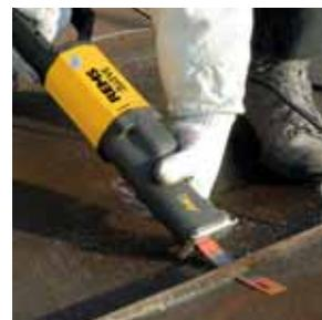
Высокопроизводительный, суперудобный электроинструмент для универсального пиления на весу. Всего 2,4 кг. Идеально подходит для монтажа, демонтажа, ремонта.
