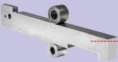
Стабильный, прямоугольный ходовой маятник Из прочной, специальной стали, по направлению нагрузки точно посажен на игольчатые подшипники, которые направляют маятник с обеих сторон по всей длине хода, для ровного прямоугольного без сколов реза даже при жесткой эксплуатации с многократно усиленным давлением на пыльное полотно, например, при использовании бугеля. Для сверхдолгого срока службы.
