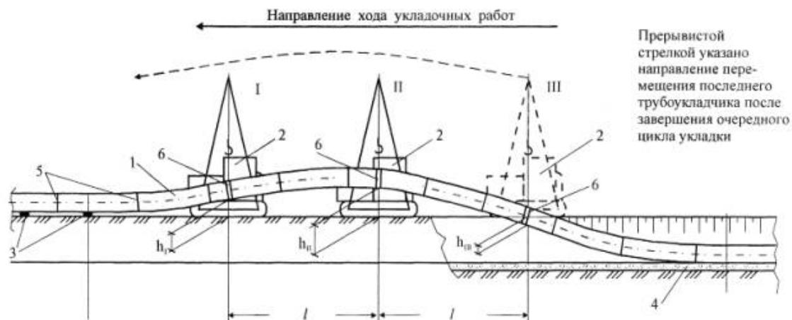
Рис. 14.2. Технологическая схема укладки длинномерных плетей при строительстве трубопроводов из стеклопластиковых труб
