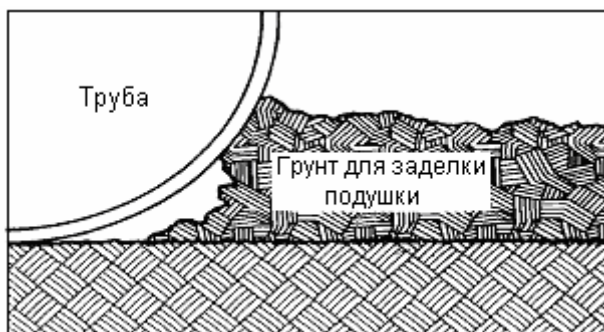
Неправильная заделка подушки
