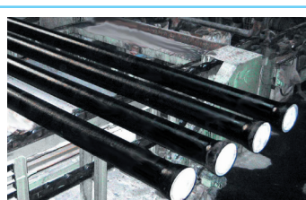
8. Участок нанесения наружного завершающего покрытия
