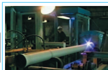
6. Участок нанесения цинкового покрытия
