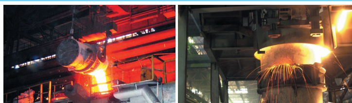
2. Плавильное отделение (десульфурация, доведение до заданного химического состава чугуна, модифицирование)
