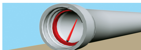
5. Смазка внутренней поверхности уплотнительного кольца
