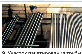
9. Участок пакетирования трубы (до DN 300 мм) и окончательного контроля качества
