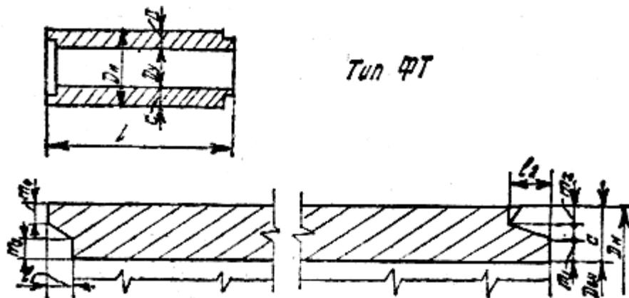
Рис.45. Размеры, мм, и масса, т, железобетонных труб типа ФТ
