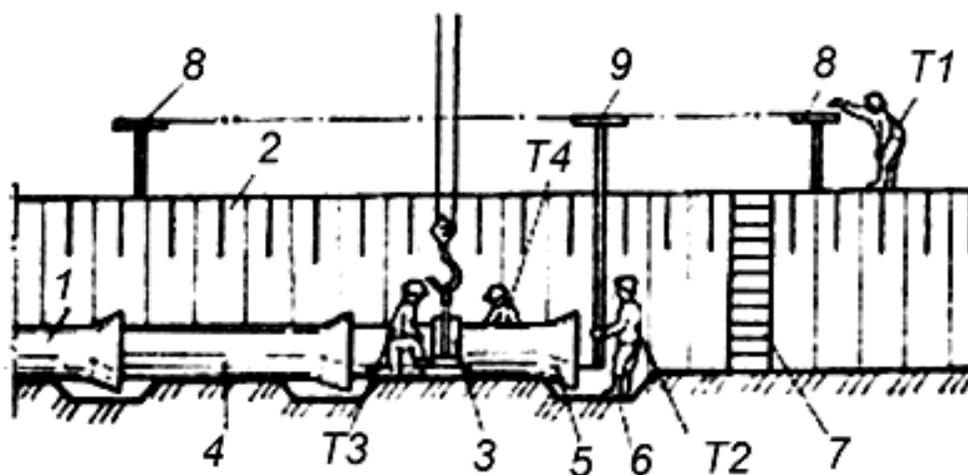
**Рис.10. Выверка положения трубы в плане по вешкам**
