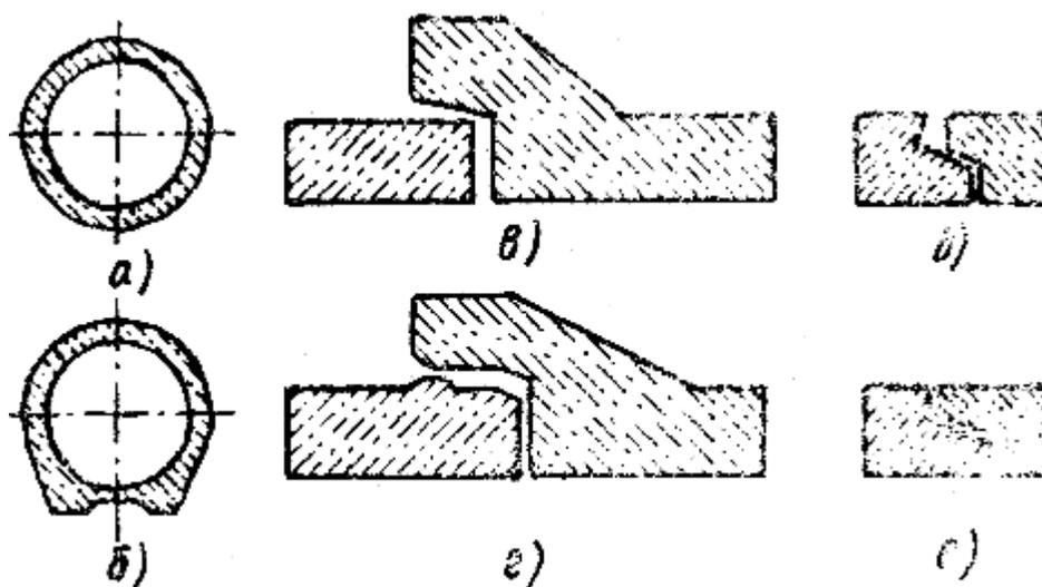
Рис.41. Железобетонные безнапорные трубы и их соединения:
