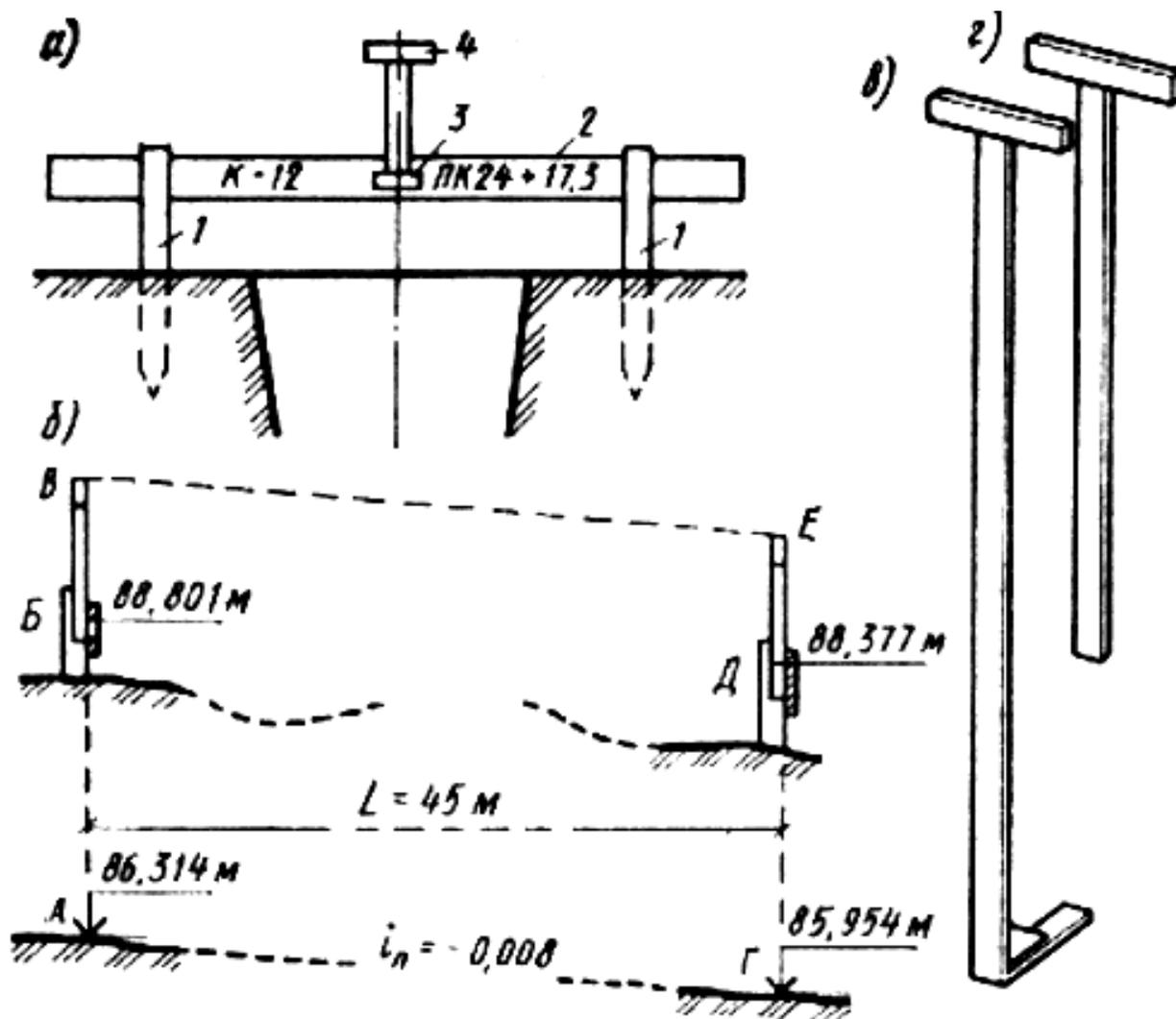
Рис.1. Разбивка траншей трубопроводов
