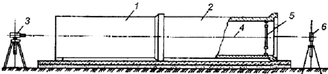
Рис.6. Способ укладки труб по лучу лазерного нивелира (визира)
