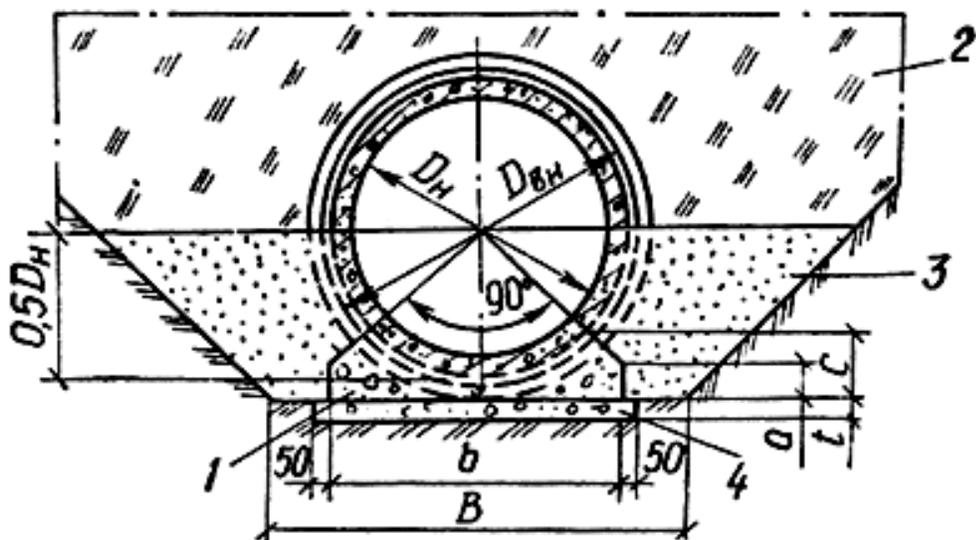
Рис.21. Укладка труб на бетонное основание
