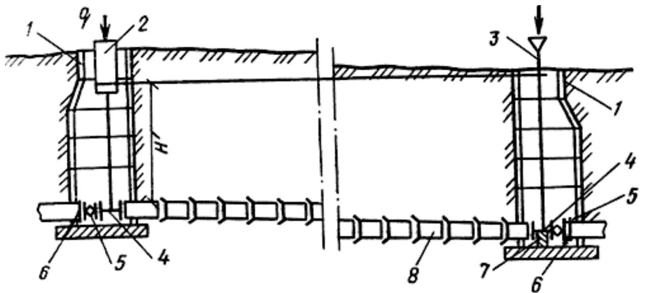
Рис.38. Схемы приемочного испытания безнапорного трубопровода с колодцем без гидроизоляции
