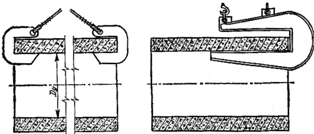
Рис.7. Торцевой захват и монтажная скоба для железобетонных труб
