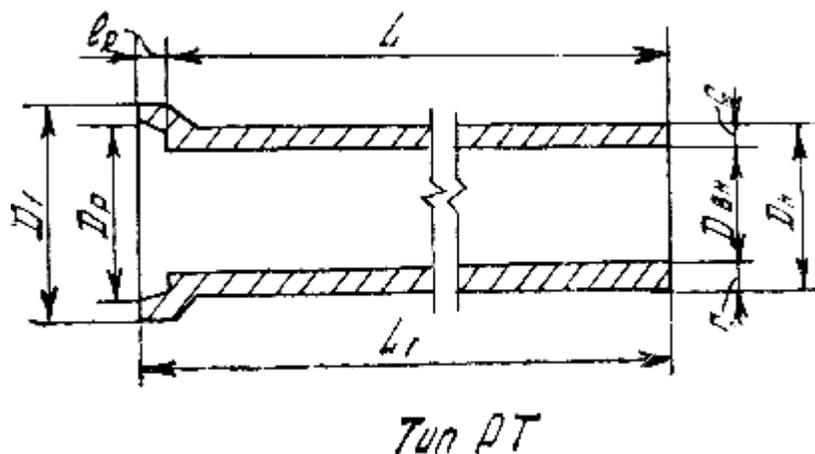
Рис.42. Размеры, мм, и масса, т, железобетонных труб типа РТ
