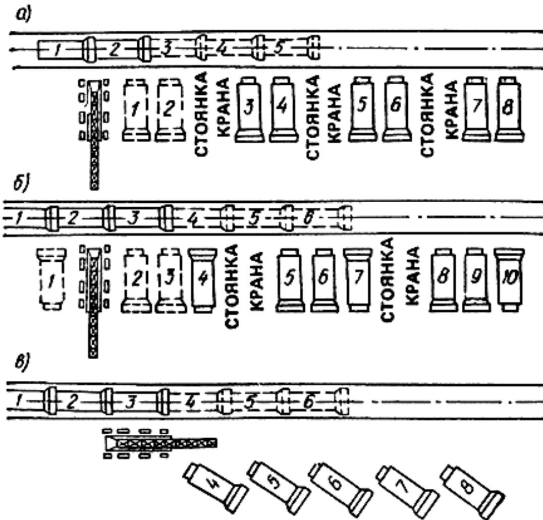
Рис.18. Раскладка раструбных труб по трассе трубопровода
