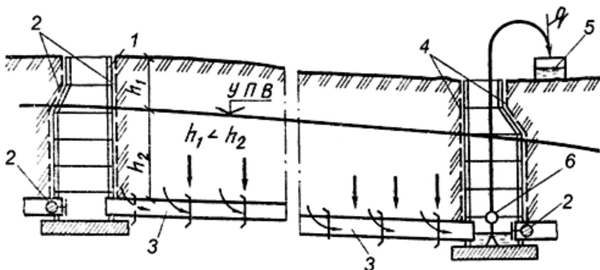
**Рис.40. Схемы приемочного испытания безнапорного трубопровода с колодцем с наружной гидроизоляцией**
