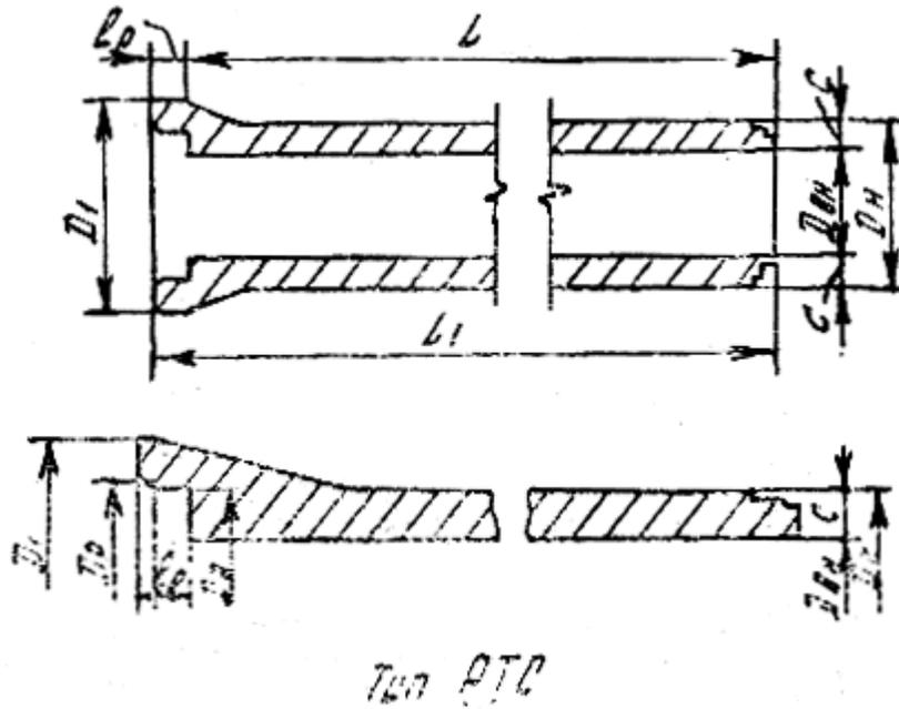
Рис.44. Размеры, мм, и масса, т, железобетонных труб типа РТС
