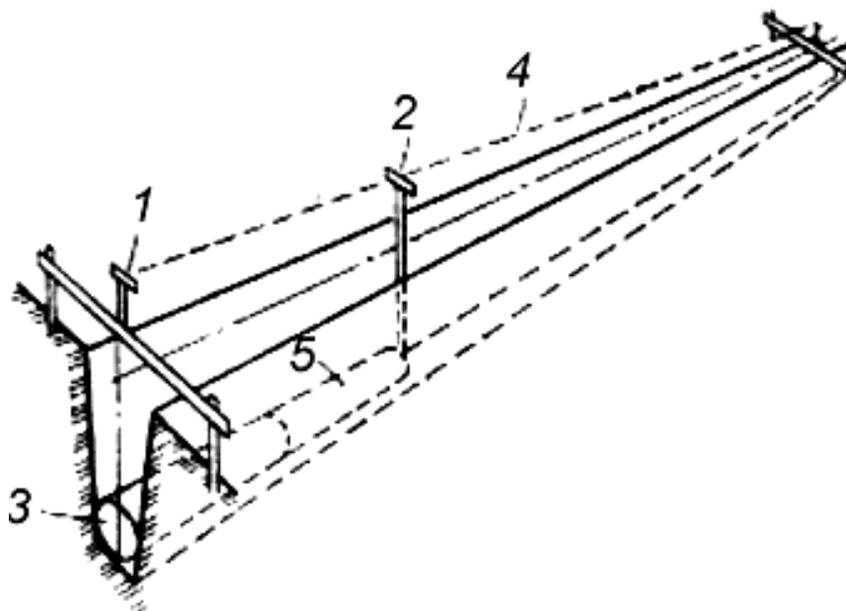
**Рис.4. Способ укладки труб по заданному направлению и уклону с помощью ходовой и постоянных визирок (визуальный способ)**
