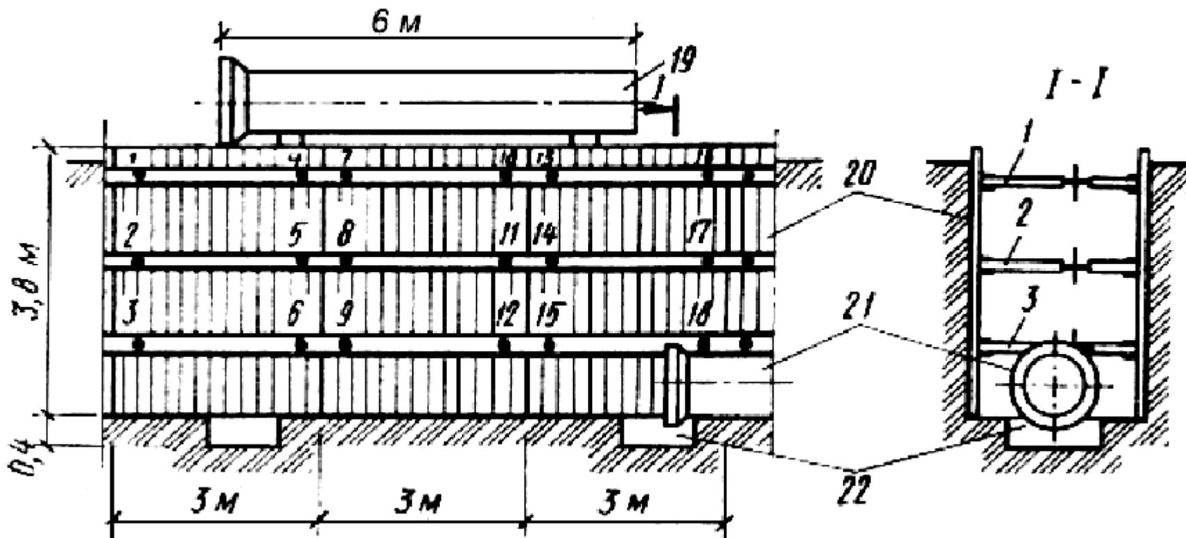
Рис.2. Установка креплений
