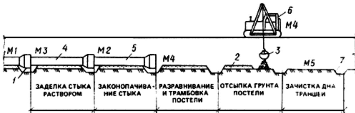
Рис.12. Общая схема размещения механизмов и исполнителей при прокладке трубопровода
