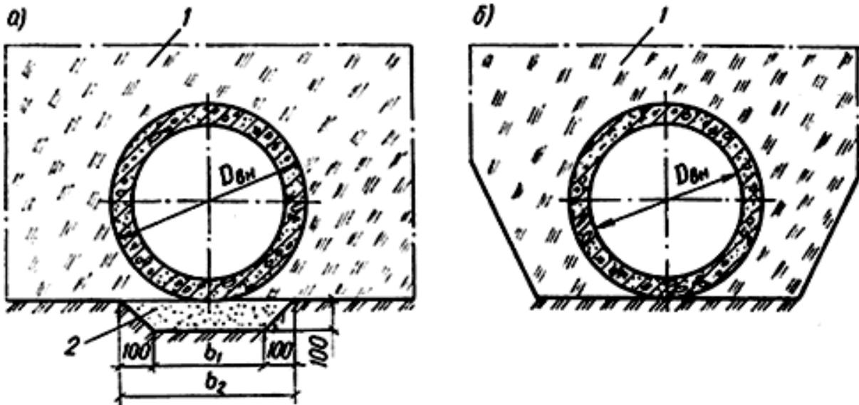
Рис.20. Укладка трубопроводов  $D_{\text{вн}} = 300 \div 500$  мм на естественное основание а - глинистое; б - песчаное; 1 - засыпка местным грунтом с уплотнением (пазухи до оси трубопровода засыпают с уплотнением до  $k \geq 0,95$ ); 2 - песчаная подготовка с уплотнением до  $k \geq 0,95$  (размеры  $b_1$  и  $b_2$  принимаются по альбому)
