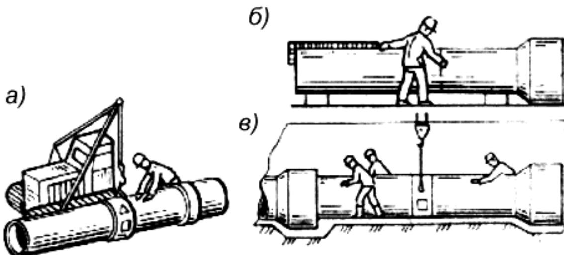
Рис.14. Разметка центра тяжести трубы, строповка трубы и подводка гладкого конца трубы к раструбам ранее уложенной
