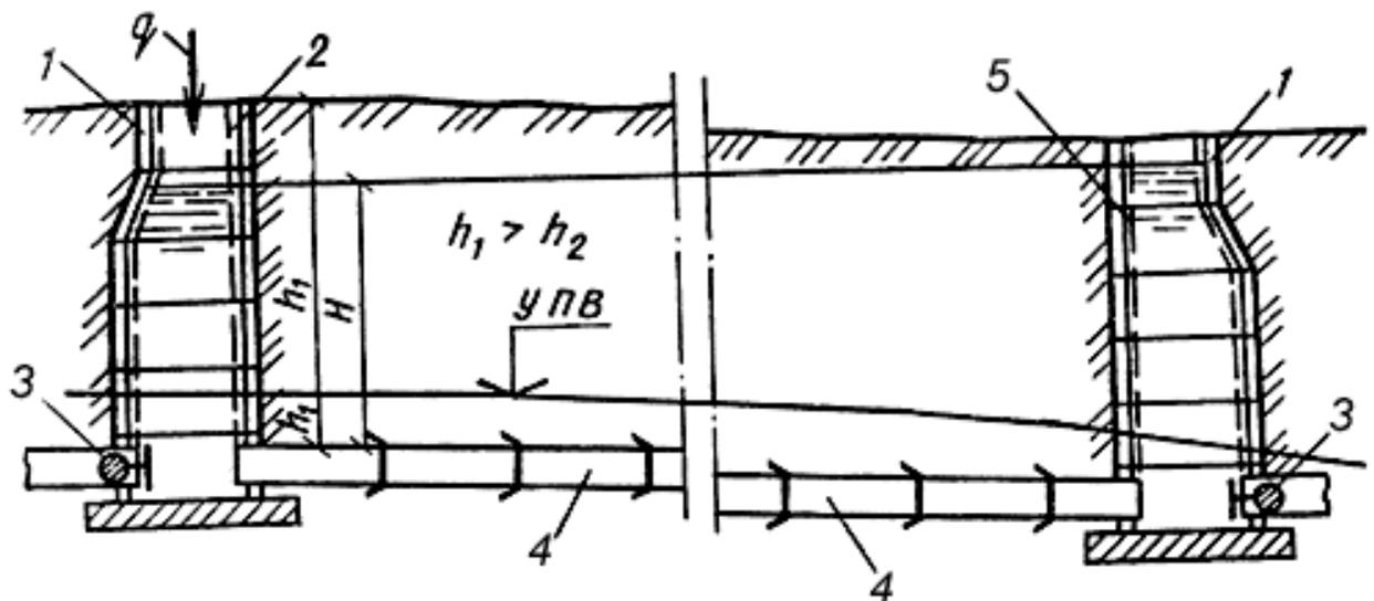
**Рис.39. Схемы приемочного испытания безнапорного трубопровода с колодцем с внутренней гидроизоляцией**
