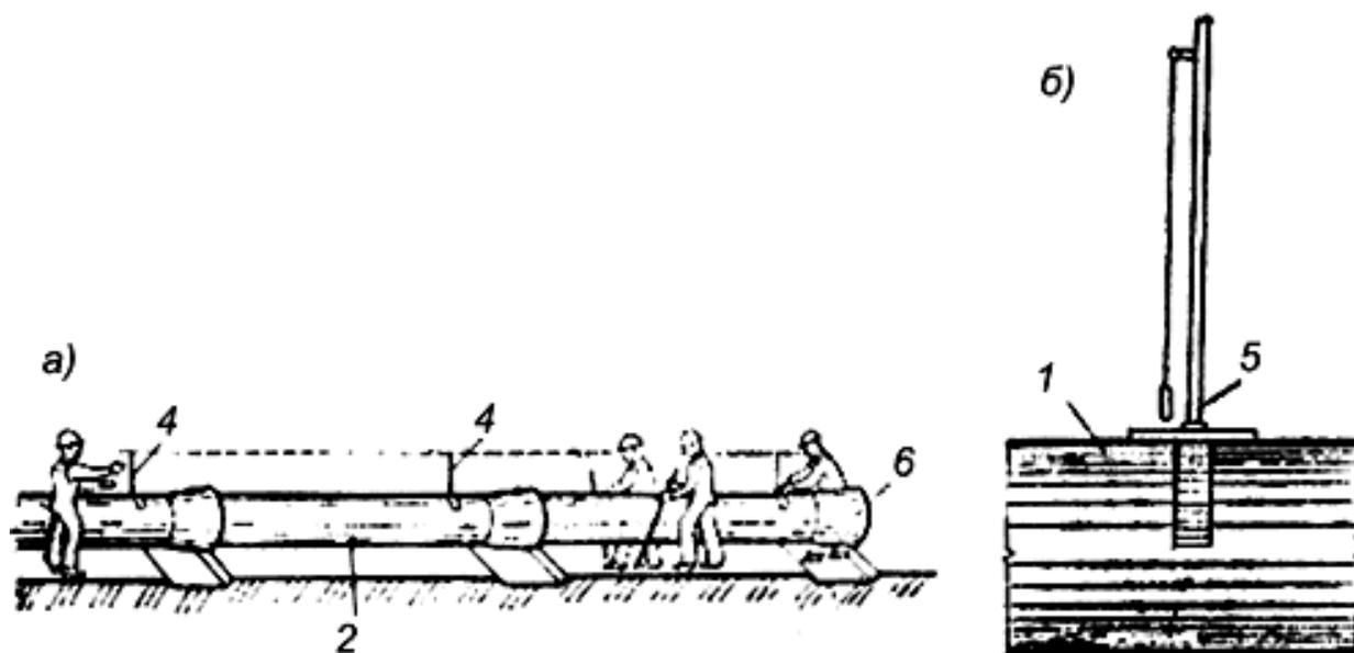
Рис.11. Центровка трубы и инвентарная вешка с отвесом
