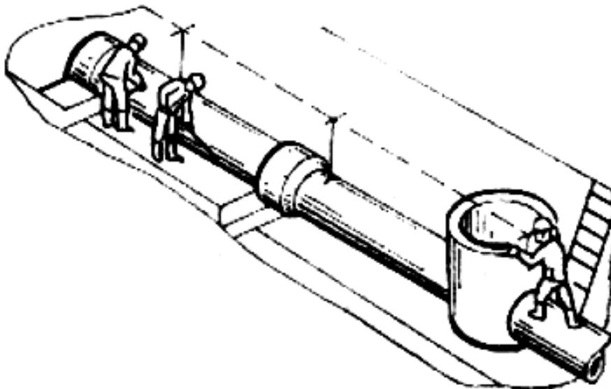
Рис.16. Выверка положения трубы по горизонтали
