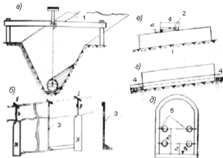
**Рис.37. Контроль точности укладки труб:**
