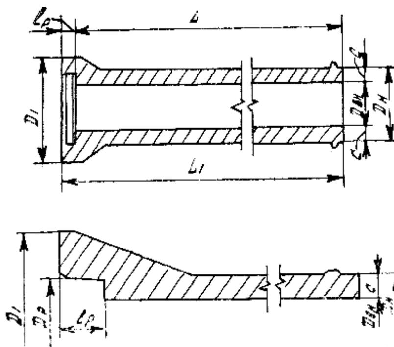
Рис.43. Размеры, мм, и масса, т, железобетонных труб типа РТБ
