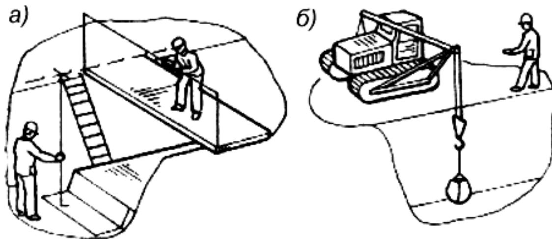
Рис.13. Проверка величины срезки и подача грейфером песчано-гравийной смеси для устройства основания
