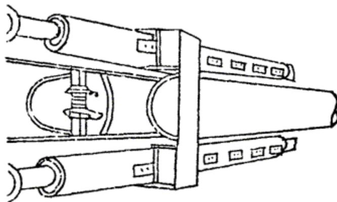
Схема работ при продавливании грунта
