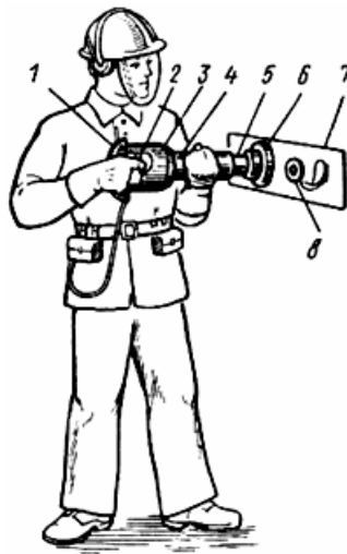
Рис.12. Крепление монтажным пистолетом ПЦ-84:
