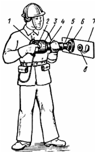
Рис.8. Крепление монтажным пистолетом ПЦ-84:
