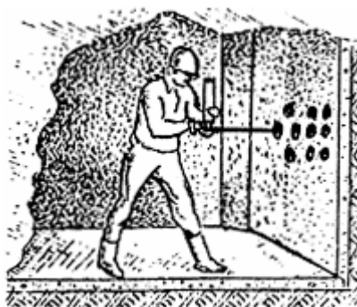
Рис.5. Заполнение ограниченного объема канала полимером из аэрозольного баллона
