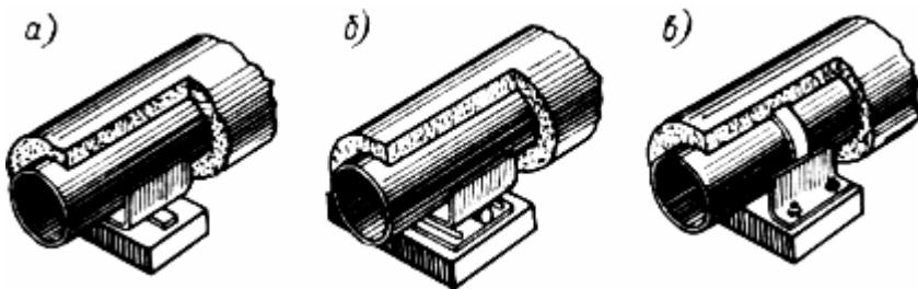
Рис.1. Опоры в теплофикационных каналах
