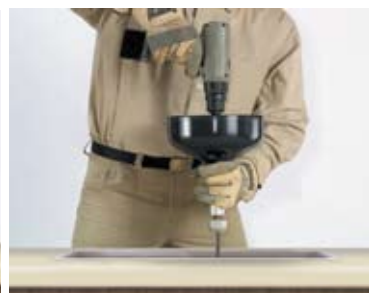
Прочистка с использованием электродрели
