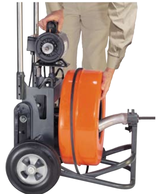
Барабан легко снимается (малый барабан используется для труб от 50мм)
