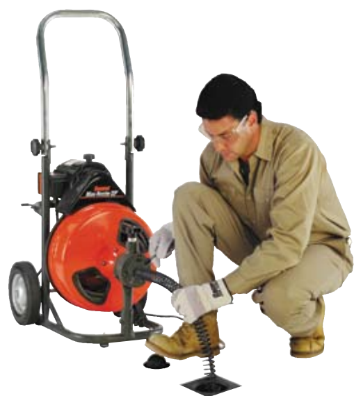
Очистка слива. Оператор управляет скоростью подачи спирали
