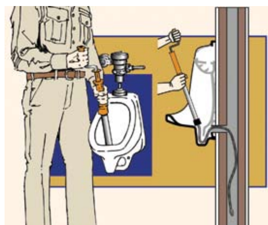
Прочистка засора писсуара
