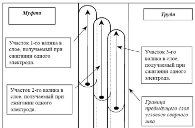
Рисунок 5.12 - Последовательность сварки слоев шва “муфта - труба” ступенчатым методом
