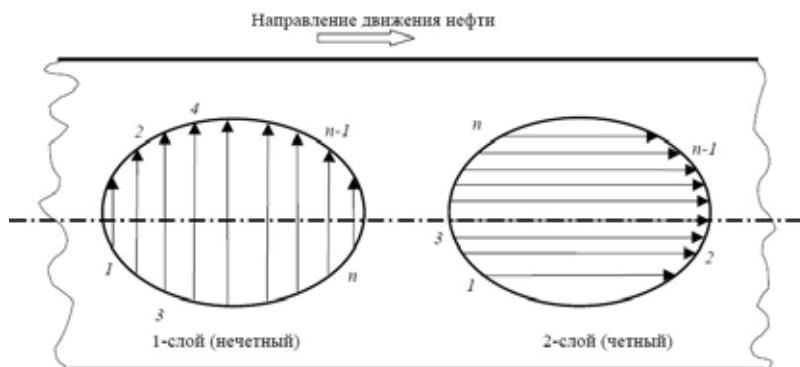
Рисунок 5.23 - Порядок наложения валиков четных и нечетных слоев при заварке выборки
