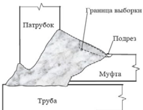
Рис. 3 - Форма поперечного сечения ремонтного шва сварного соединения “патрубок - муфта - труба”. Ремонт подреза в облицовочном слое шва.
