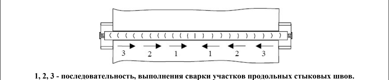
Рис. 4 Схема сварки продольных стыковых швов полумуфт обратноступенчатым способом.
