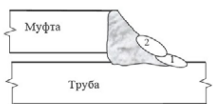
Рис. 5 - Форма поперечного сечения ремонтного шва сварного соединения “муфта - труба”. Ремонт подреза в облицовочном слое шва.
