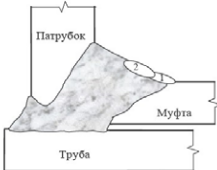
Рис. 3 - Форма поперечного сечения ремонтного шва сварного соединения “патрубок - муфта - труба”. Ремонт подреза в облицовочном слое шва.
