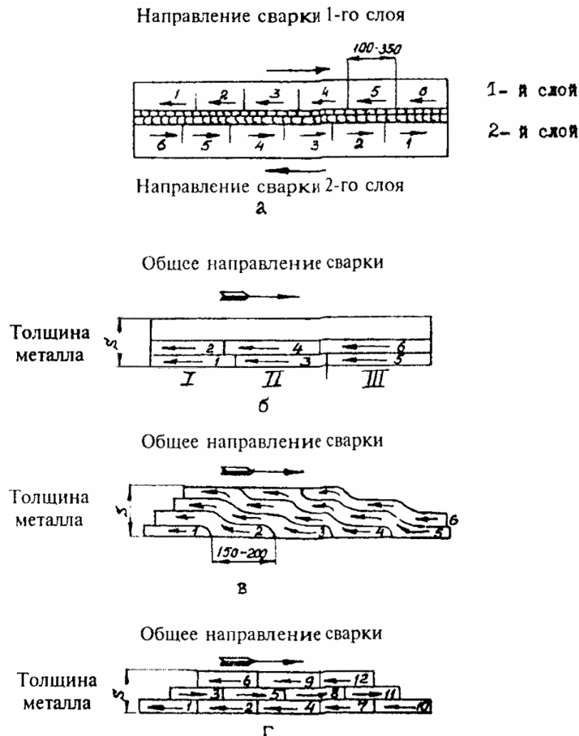
Рис. 6.1. Схемы сварки обратноступенчатым способом (а), способом «двойного слоя» (б), горкой (в) и каскадом (г)
