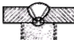
Рис.30. Соединение стыковое со скосом двух кромок двустороннее на флюсовой подушке С 33
